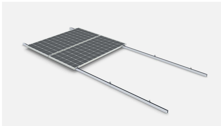
Ilustración 31: Fijación de los módulos fotovoltaicos mediante perfil corrido
