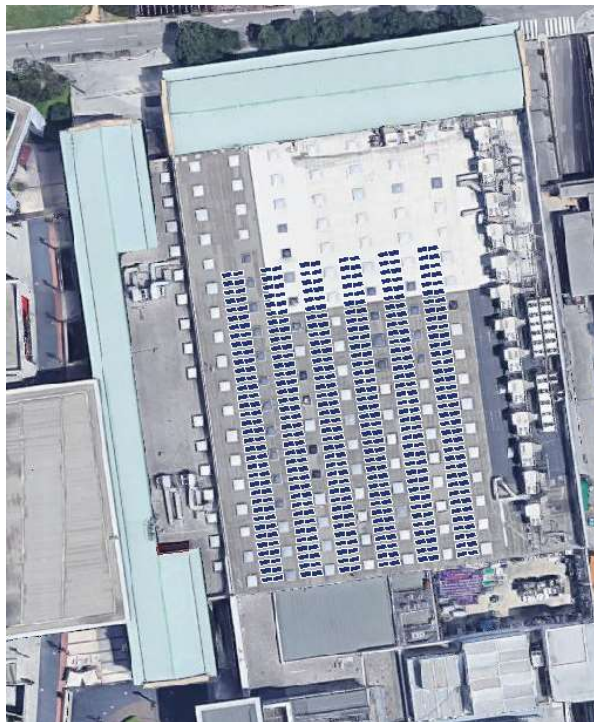
Ilustración 21: Layout de la cubierta 3 con una disposición inclinada 15° fijada a excedente 30%. Fuente: Elaboración propia
