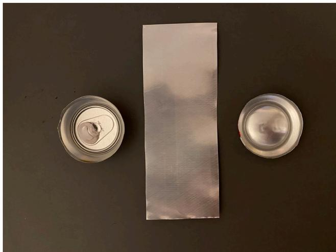
**Fig. 22.** Imagen 5/10 para muestra del proceso de transformación de lata a modulo .Gil, J. Foto 5 (2023). Lámina sin sobrante. (19 x 8)
