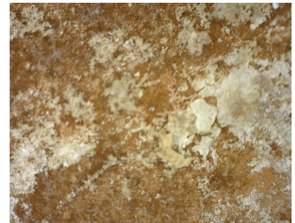
Fig. 61. Fotografía hecha con microscopio digital portátil (Dinolite) de concreciones calcáreas.
