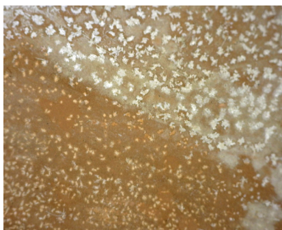
Fig. 51. Fotografía hecha con microscopio digital portátil (Dinolite) de velo blanquecino y cristalizaciones.
