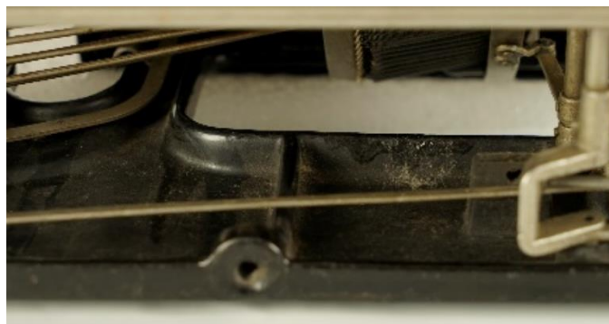
Figura 17. Pols greixada a la part inferior de la màquina.
