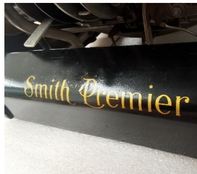
Figures 60. Detall part darrera protegida amb Paraloid® B-44
