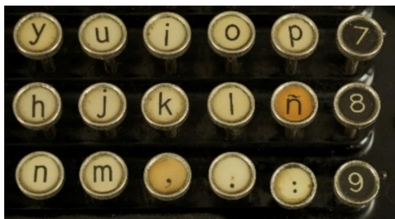
Figura 18. Brutícia greixada de les tecles de baquelita.
