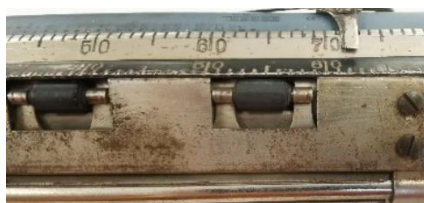
Figures 50 i 51. Estat del metal del corró blau abans i després de la neteja.
