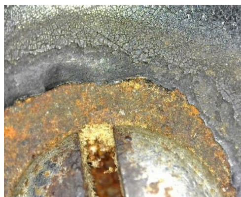
Figura 23. Detall de l'oxidació d'un caragol amb el microscopi digital Dino-lite® Premier model AM4113 T-TVW (R4).
