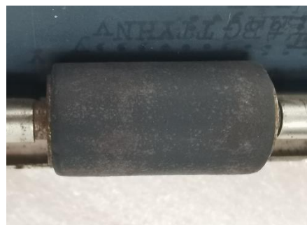
Figura 47. Estat del corró de cautxú després de la neteja.
