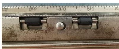
Figures 48 i 49. Estat del metal del corró blau abans i després de la neteja.
