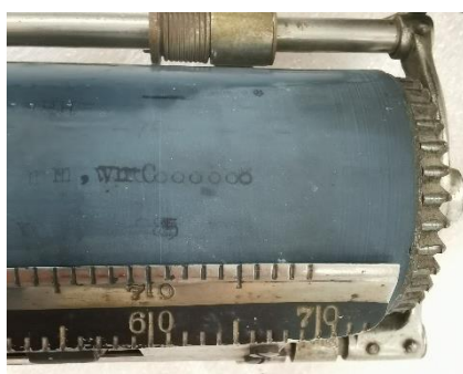
Figura 42. Estat del corró blau abans de la neteja.
