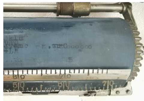
Figura 43. Estat del corró blau després de la neteja.
