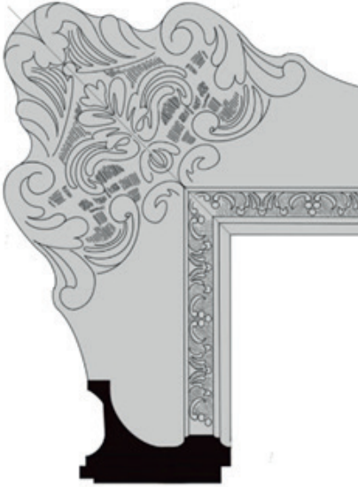
Ilustración 28. Boceto explicativo del Diseño y corte en sección del marco. Elaboración propia.
