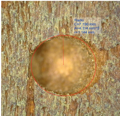
Ilustración 31. Fotografía microscopía óptica ( Dino-Lite digital microscope 55x ). Ataque de microorganismos.
