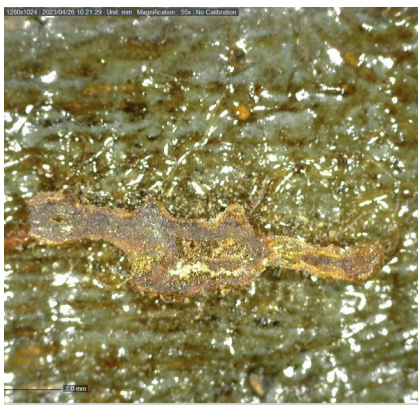
Ilustración 40. Fotografía microscopía óptica ( Dino-Lite digital microscope 55x ). Concreción de barniz.
