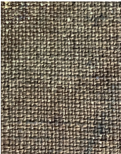
Ilustración 24. Detalle ligamento tafetán del soporte textil.
