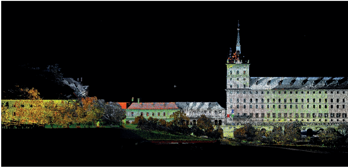
Figura 10. Pilar Chías, 2017. Jardín Monasterio de El Escorial, nube de puntos obtenida con un escáner láser con un alcance de 60 m. Obsérvese que el escáner es capaz de registrar datos de los chapiteles de las torres –a más de 200 pies de altura– y de las cubiertas.
