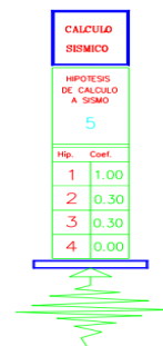
Img. 45: Hipótesis de cálculo a sismo.
