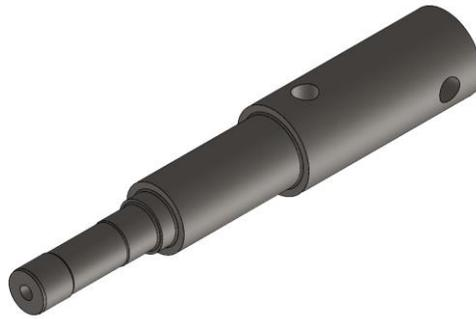
*Ilustración 26. Eje simple de salida de motorreductor*
