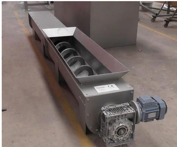
*Ilustración 8. Transportador helicoidal de hélices tipo palas*
