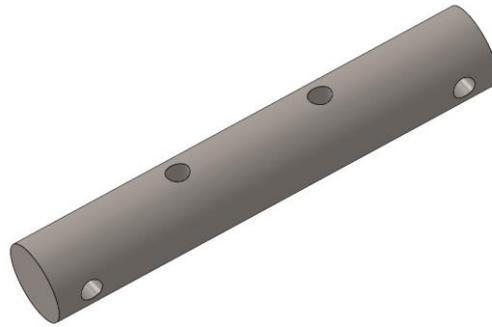
*Ilustración 28. Eje simple apoyo de acoplamiento intermedio*
