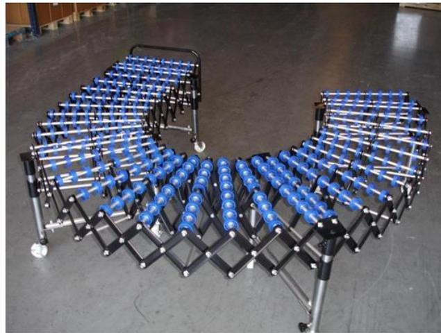
*Ilustración 3. Cinta transportadora de roldanas, colocada con un giro de 180°*
