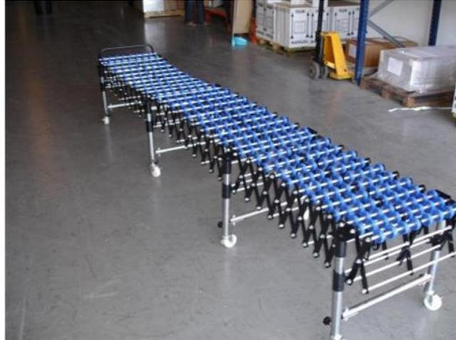
*Ilustración 2. Cinta transportadora de roldanas recta*
