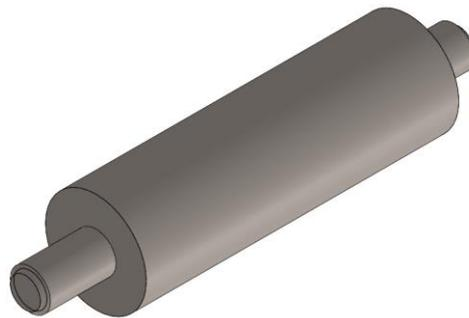
*Ilustración 53. Eje soporte de brazo de reacción*
