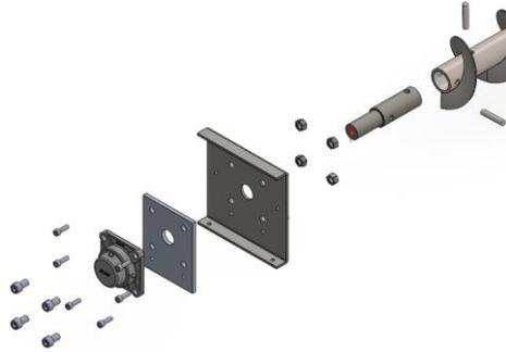
Ilustración 68. Soporte final de transportador sinfin
