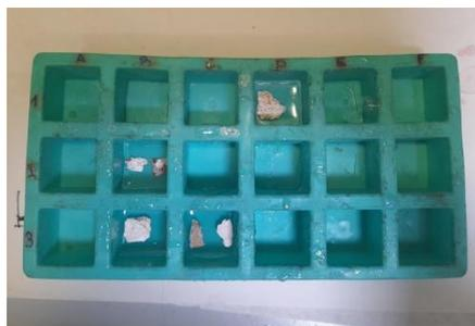
Fig. 75. Muestras englobadas en resina Ferpól 1973 en molde de silicona.
