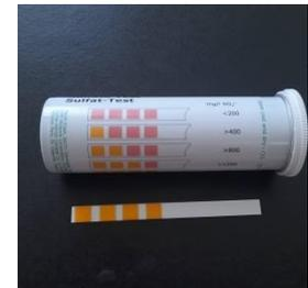
Fig. 66, 67, 68. Tests reactivos de cloruros, nitratos y sulfatos sobre muestra 1.
