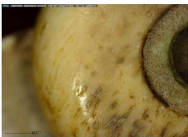
Fig. 23. Detalle de la superficie de baquelita en las botoneras (obtenido con microscopio Dino-Lite 55 aumentos).
