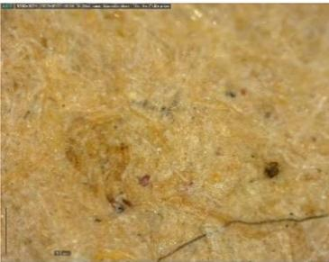
Fig. 25. Detalle de las fibras de papel (obtenido con Microscopio Dino-lite 220 aumentos)
