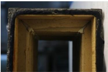
Fig. 22. Detalle del borde del fuelle desmontado con la lana adherida por la zona del borde.
