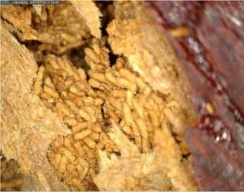
Fig. 33. Detalle de orificios de *Anobium Punctatum* con huevos inactivos (obtenido con microscopio Dino-Lite 55 aumentos).
