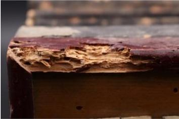
Fig. 32. Detalle del ataque de *Anobium Punctatum* en la caja del diapason.
