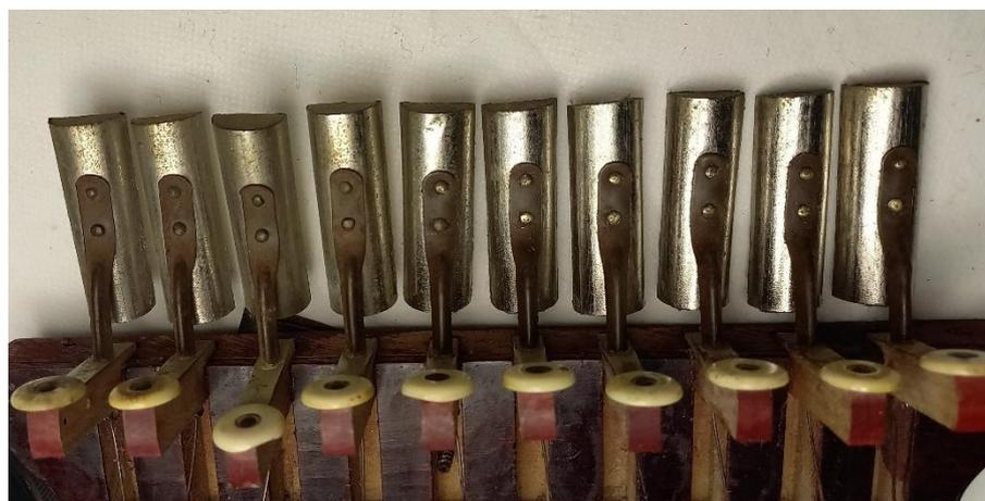
Fig. 53. Limpieza de las piezas metálicas de la botonera. Sección izquierda sin realizar limpieza.
