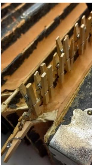
Fig. 47. Adhesión con Vinavil® 59 y secado con presión.
