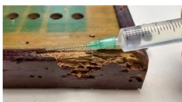
Fig. 44. Inyección del tratamiento con Paraloid® B72 en la madera.
