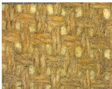
Figura 7. Soporte textil observado con el microscopio digital Dino-Lite® (aumento x 50).
