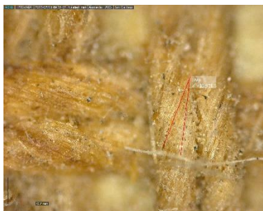
Figura 10. Detalle de las fibras con el microscopio digital Dino-Lite® (aumento x200). Se observa la torsión de los hilos.
