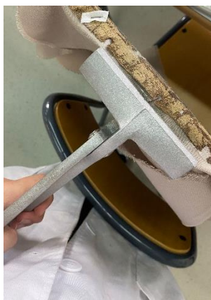
Figura 71: Tensado de bordes.
