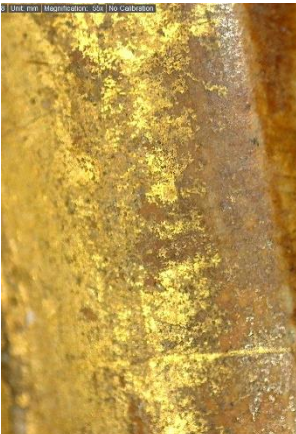
Figura 57: Detalle del desgaste de la lámina metálica.
