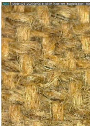
Figura 30: Detalle del soporte textil. Fotografía realizada con microscopio a 55x.
