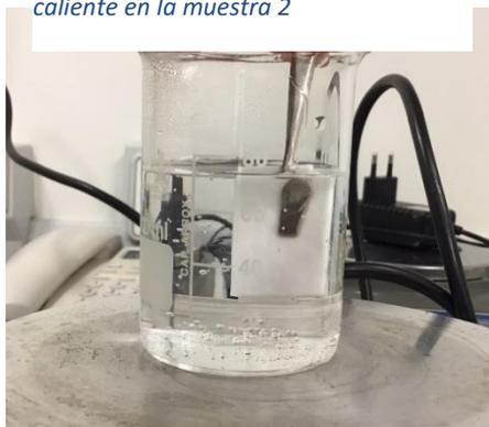
Figura 57. Fotografía proceso de sumergir la muestra en agua caliente
