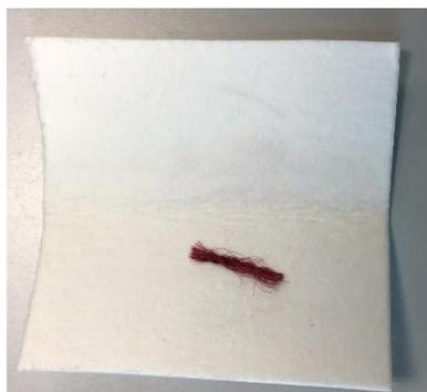
Figura 55. Realización de la prueba de solidez de los tintes mediante agua fría en la muestra 2
