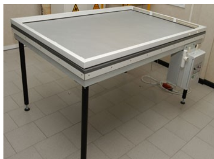
Fig. 68 Mesa caliente de baja presión
