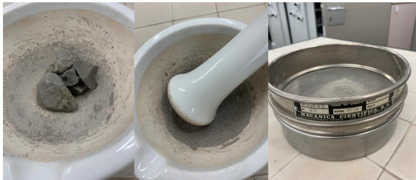
Figura 16. Proceso preparaci6n marga. De izquierda a derecha: matriz yacimiento Chera 0, molido de la matriz y tamizado a 400 $\mu$ m.
