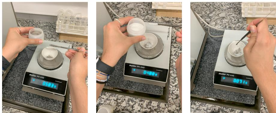
Figura 17. Proceso preparaci6n de la masilla del estuco. De izquierda a derecha: Pesaje 40% matriz yacimiento + 40% microesferas de vidrio + 20% Paraloid B72 disuelto en acetona al 25%.
