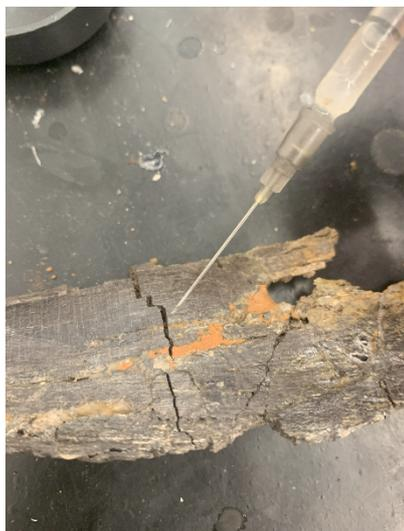
Figura 12. Proceso de consolidación por inyección, mediante el empleo de Paraloid B72 disuelto acetona al 10%.
