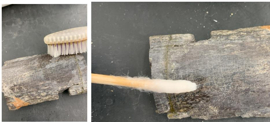
Figura 11. Proceso de limpieza de restos de consolidante con acetona. mediante el empleo de hisopos humectados (izquierda) y empleando una brocha de cerda suave (derecha).
