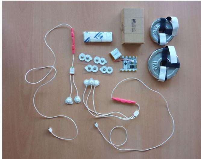
*Figura 60. Instrumentos de medición empleados en los experimentos: (A) placa Arduino, (B) cable con salida EMG, (C) Electrodos, (D) Discos de acero de 0,5 kg y 1 kg y (E) Esparadrapo hipoalergénico elástico.*
