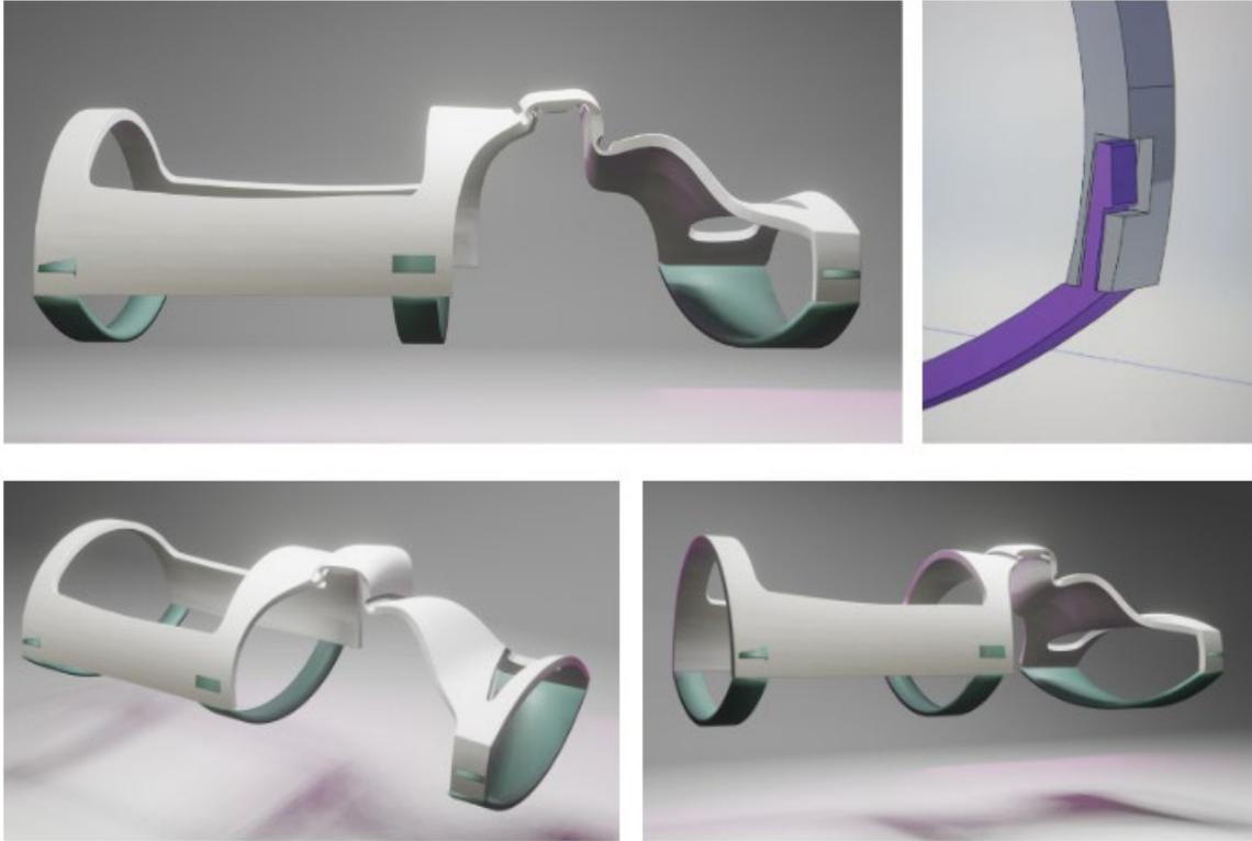
*Figura 78. Diseño de órtesis con mecanismo de 4 barras y bisagras de flexión.*
