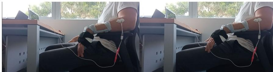
*Figura 66. Medición mano con asistencia de la órtesis más pesa de 1 kg.*
