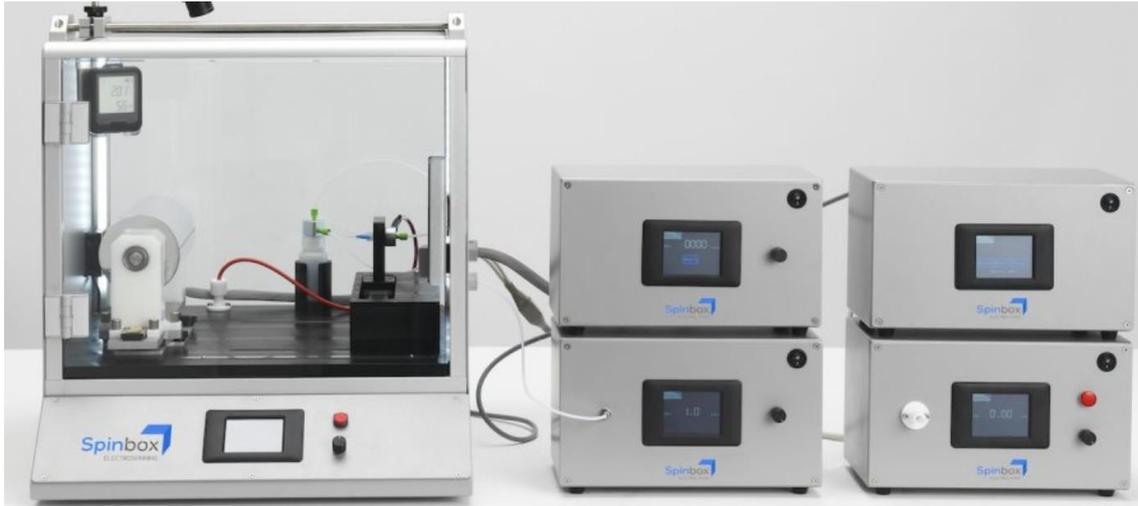
Figura 10. Equipo de electrohilatura utilizado Spinbox.
