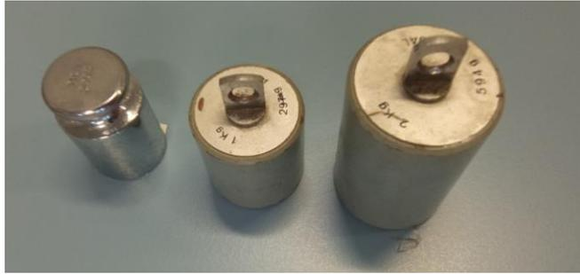
Figura 82. Pesas utilizadas en la prueba de adhesión sobre las muestras.
