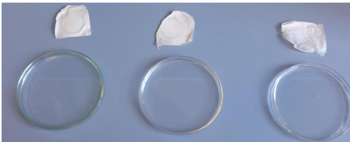
*Figura 74. Muestras de Pululano 20% para el ensayo de solubilidad en agua.*
