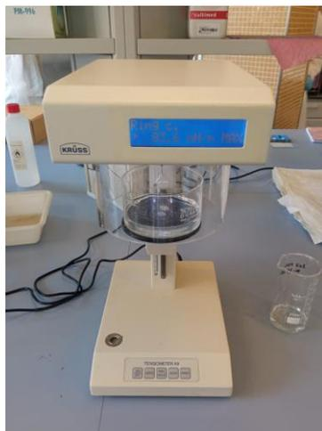
Figura 9. Tensiómetro Krüss.
