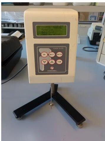
Figura 6. Viscosímetro ViscoElite-R.
