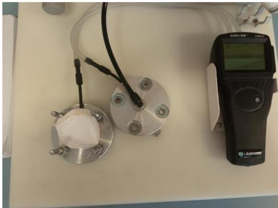
Figura 88. Montaje para el ensayo de transpirabilidad de las muestras
