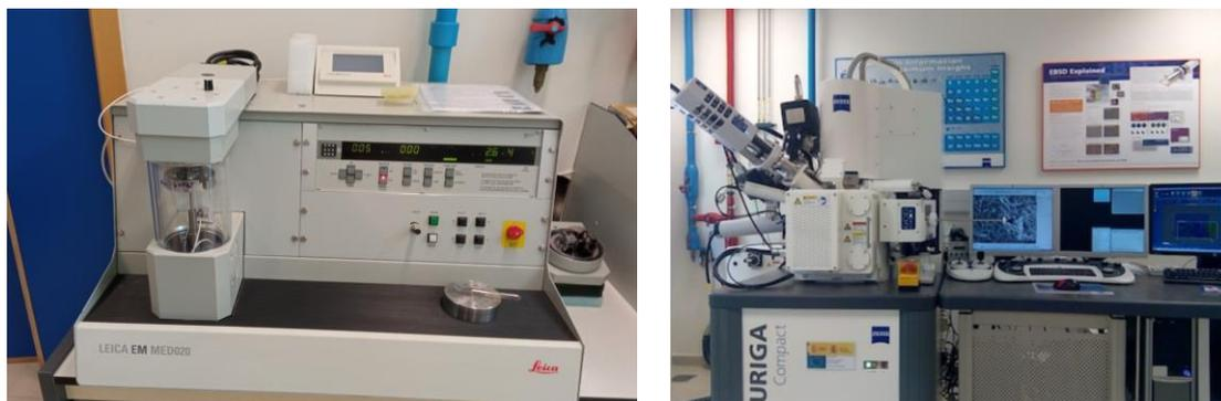
Figura 13. A la izquierda el Sputter Coater y a la derecha Microscopio Electrónico de Barrido de Emisión de Campo con Cañón de Iones Focalizados (FIB).
