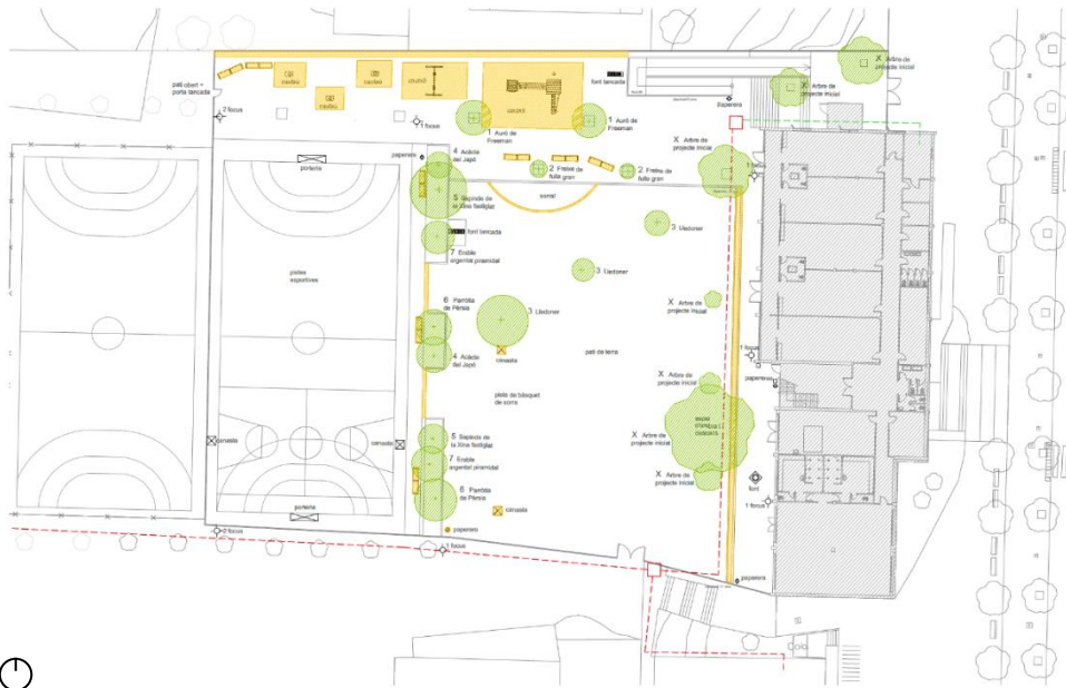
Figura 54. Plano de la Escuela Salvador Llobet con análisis de los elementos a desplazar o eliminar en la nueva intervención. ('Adequació Del Pati de l'Escola Salvador Llobet' n.d.)
