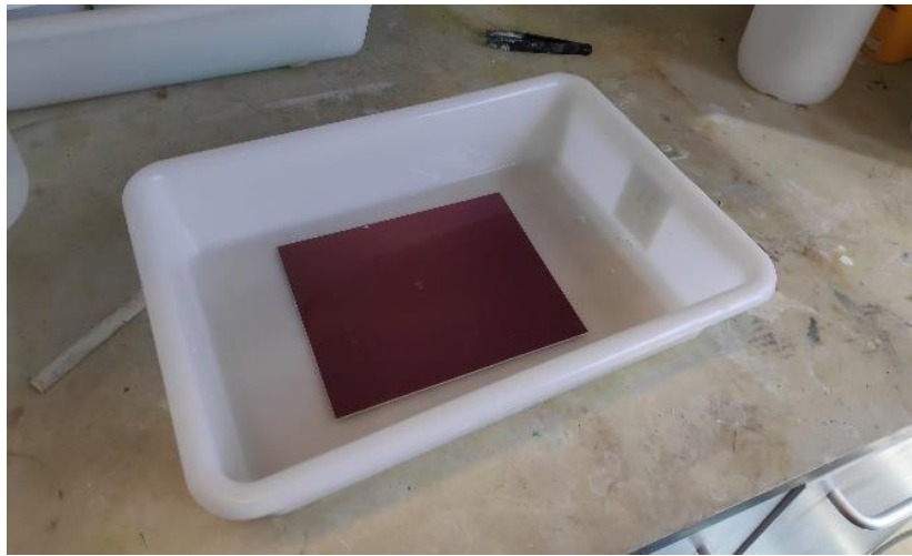
Ilustración 18 proceso de revelado de la placa en sosa caustica
