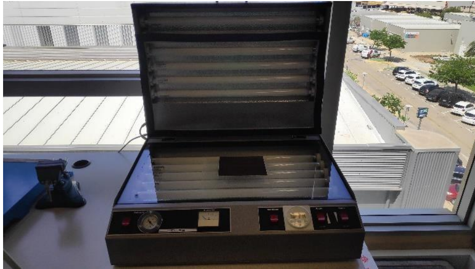
Ilustración 17 proceso de calcado en la insoladora
