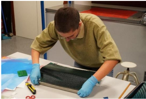
Figuras 1.10.19 y 1.10.20: Colocación de fibra pre-preg en la bandeja
