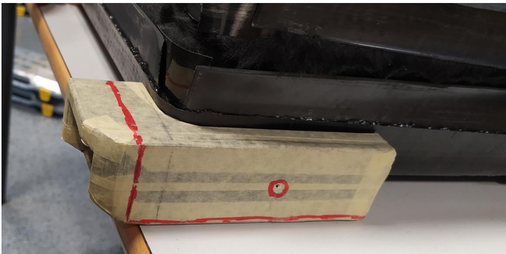
Figura 1.10.33: Colocación de la cantonera.
