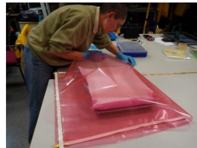
Figuras 1.10.21 y 1.10.22: Colocación de la manta térmica y la bolsa de vacío
