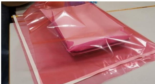
Figuras 1.10.21 y 1.10.22: Colocación de la manta térmica y la bolsa de vacío
