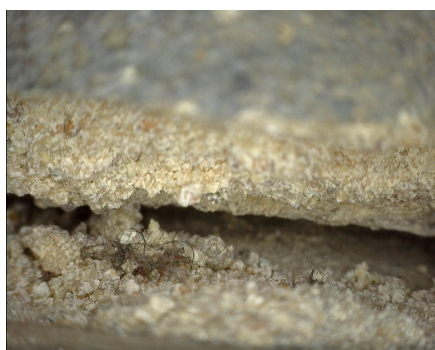
Fig. 48. Fotografía con Dino-Lite® del interior de la zona desprendida.
