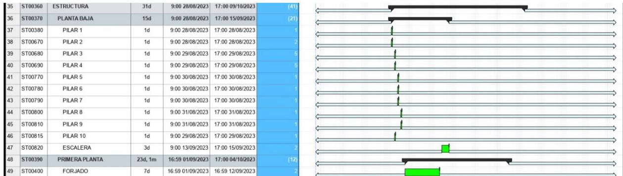
Al finalizar la estructura de planta baja y el forjado de primera planta, se inicia la ejecución de la estructura de los pilares de la primera planta y el forjado de la segunda planta. Una vez finalizados estos elementos y vinculados en el programa se inicia la ejecución de la escalera de primera planta a segunda planta.
