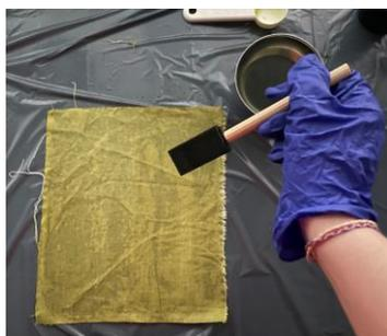
**Fig. 20.** Impregnación de mezcla
