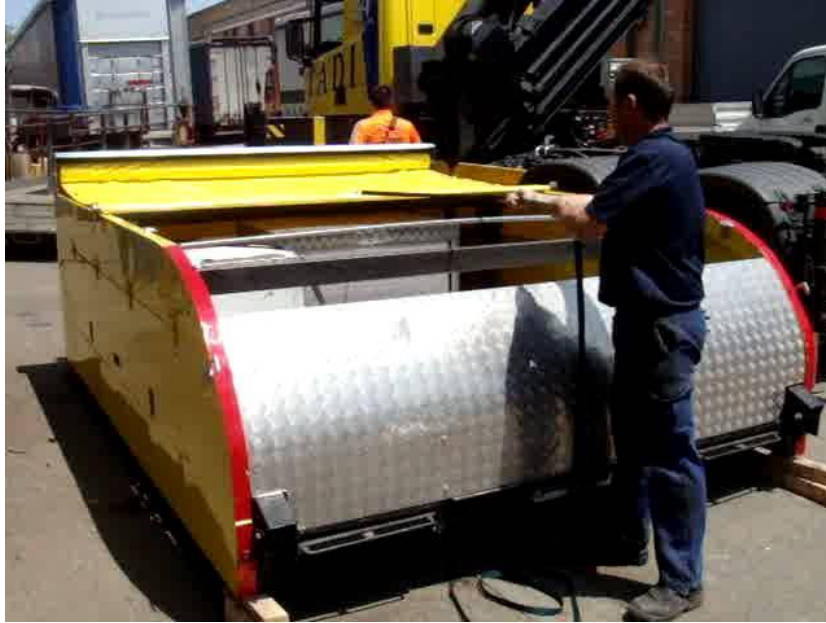
Imagen 6: Sistema de toldo enrollable con caja descubierta (Botero) [7]
