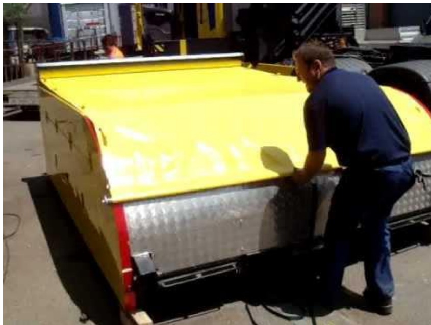
Imagen 6: Sistema de toldo enrollable con caja cubierta (Botero) [7]
