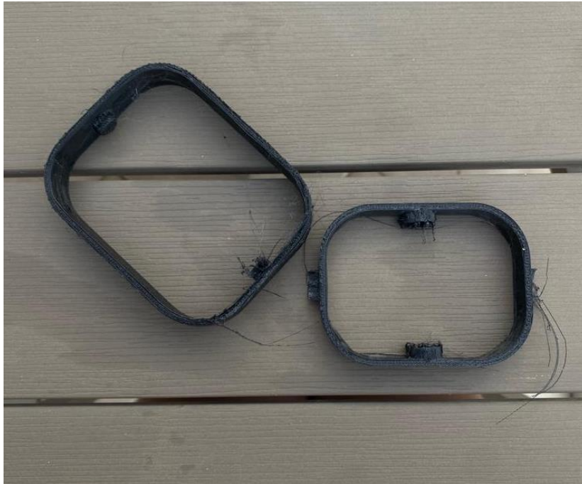
Figura 238. Piezas finalizadas con desperfectos.
