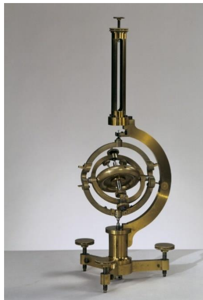
Figura 2. Giroscopio de Foucault en el "Musée des Arts et Métiers"
