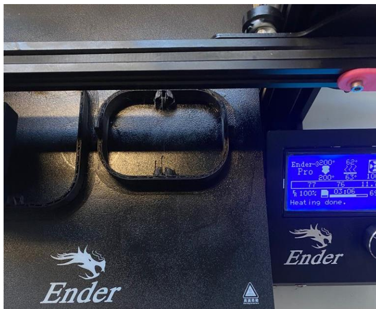
Figura 237. Construcción de los aros estabilizadores (69%).
