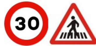
Figura 26. Señales R-301 y P-20 a disponer en la puerta de la travesía. Fuente: DGC.
