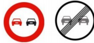
Figura 27. Señales R-305 y R-502. Fuente: Norma 8.1-IC.
