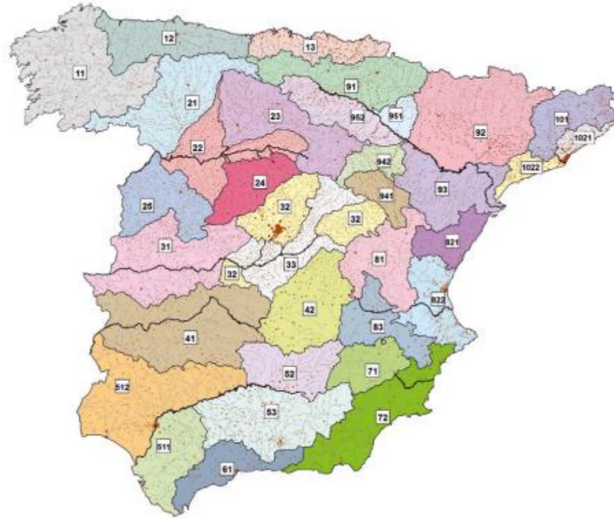
Figura 9. Regiones consideradas para la caracterización del coeficiente corrector del umbral de escorrentía. Fuente: Norma 5.2 I.C Instrucción de Carreteras.
