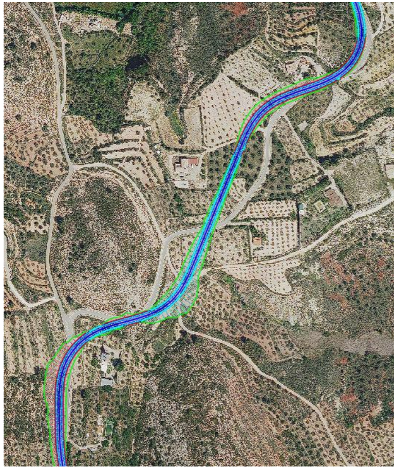
Figura 8. Cambios en el trazado y mejora de las curvas circulares Fuente: Elaboración propia.
