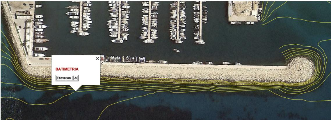
Figura 10. Batimetría a pie de dique. Fuente: Elaboración propia
