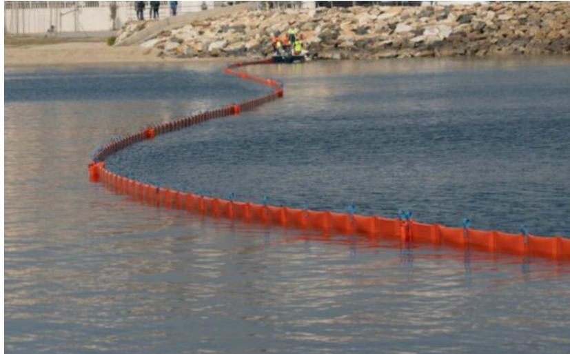
*Figura 20. Barrera de contención. Fuente: Sorbcontrol.com*
