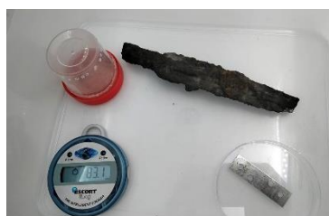
Fig. 8.4. Aumento del crecimiento microbiano sobre la pieza, causado por la excesiva humedad en el contenedor, Archivo SIP.
