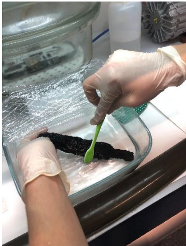
Fig. 15.12. Eliminación microorganismos mediante baño y cepillado en etanol puro, Archivo SIP.
