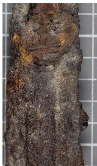
Fig. 6.2. Fotografía macro de velo blanquecino correspondiente a un ataque fúngico en activo, Archivo SIP.
