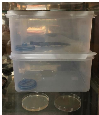
Fig. 8. 1. Primer ensayo: medios de cultivo + datalogger en contenedores con (arriba) y sin (abajo) pieza, junto con medios de cultivo en interior vitrina, Archivo SIP.
