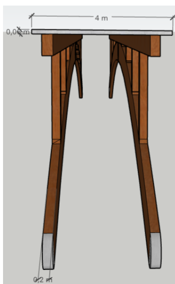
Imagen 76 y 77: Acotación en perfil y de las péndolas biarticuladas (Fuente propia)
