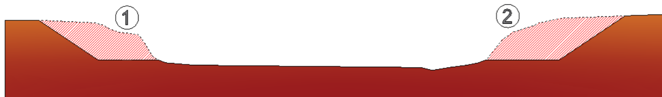
Imagen 5. Excavaciones para ejecución de estribos (Fuente: Elaboración propia)
