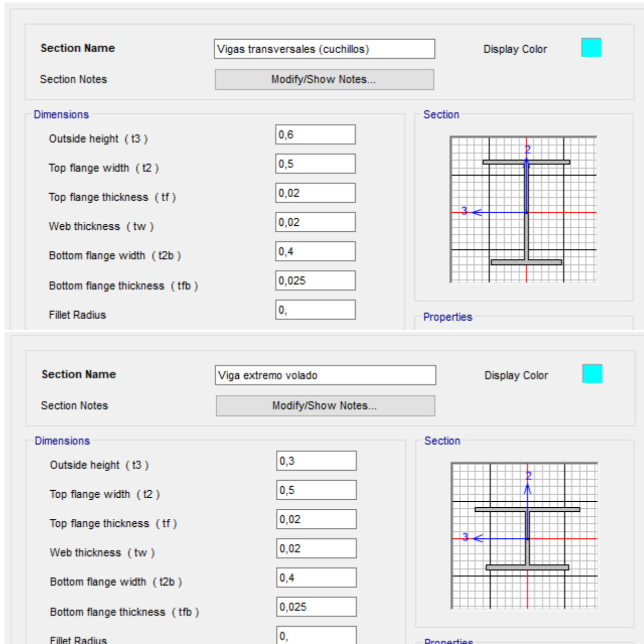
Imagen 16. Secciones cuchillos SAP2000 (Fuente: Elaboración propia)
