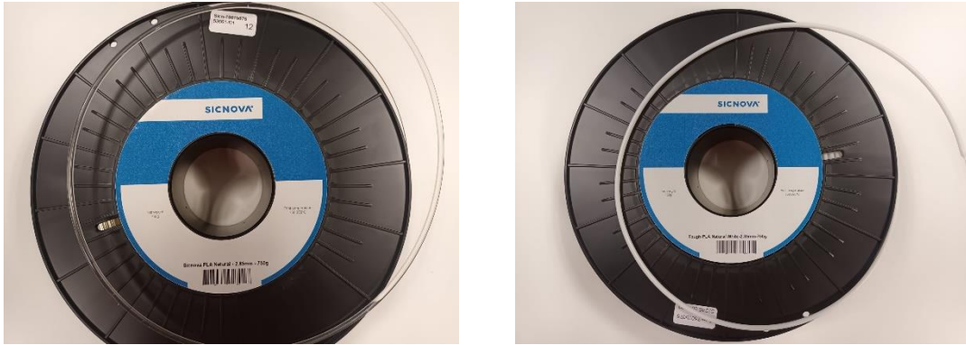
Il·lustració 7. Bobines de material emprats; PLA (esquerra) i TPLA (dreta)
