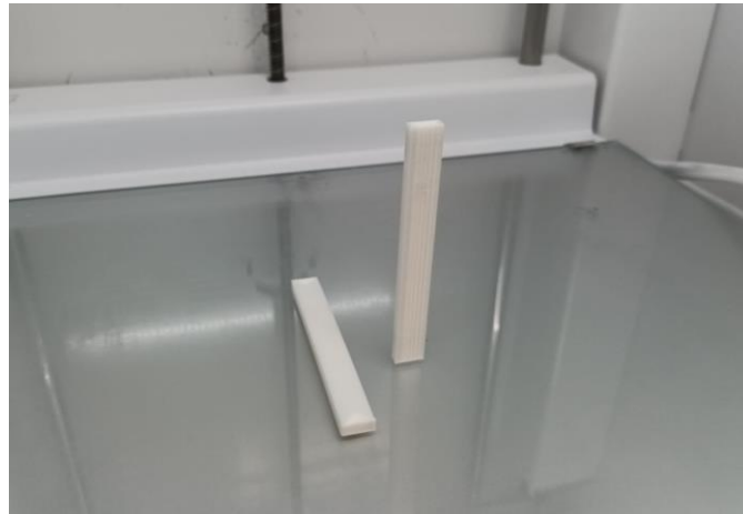
Il·lustració 10. Detall de la direcció de fabricació de les provetes: longitudinal (esquerra), i transversal (dreta)
