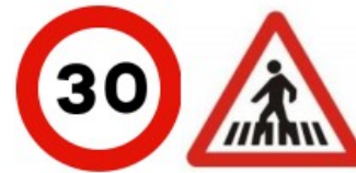
Figura 26. Señales R-301 y P-20 a disponer en la puerta de la travesía. Fuente: DGC.
