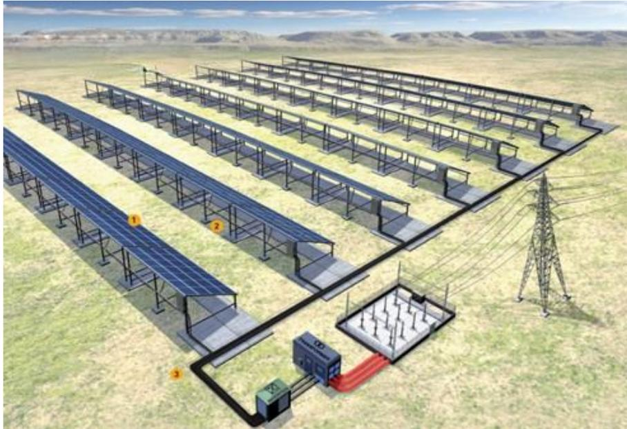
Ilustración 33. Cableado de baja tensión en parque fotovoltaico (1,2 y 3)
