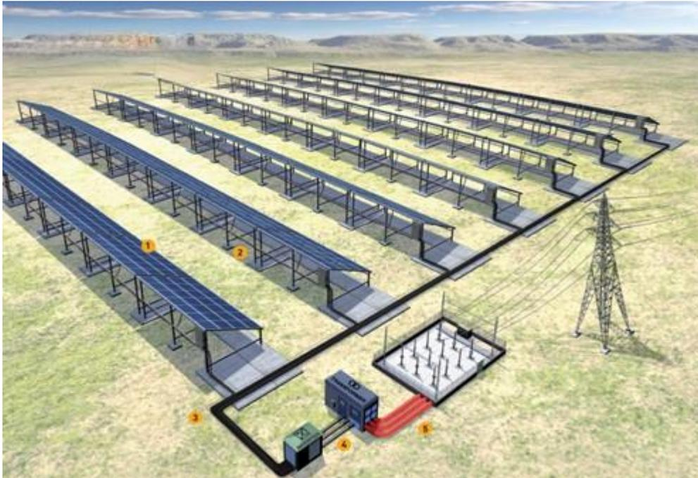
Ilustración 37. Cableado de media tensión en parque fotovoltaico (5)
