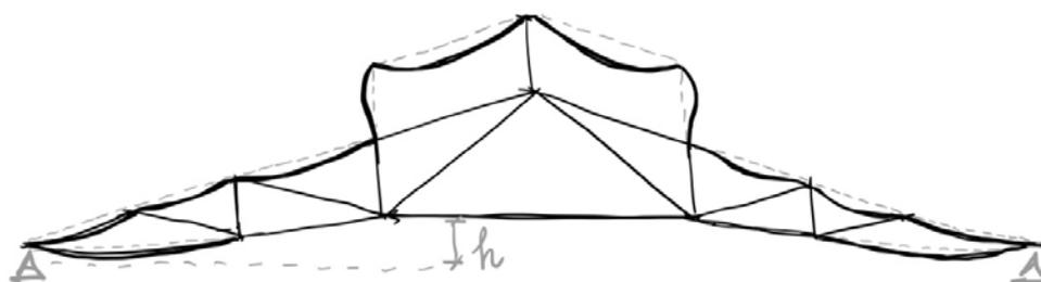
Figura 17. Deformación de la cercha con tirante inferior tripartito. Fuente: elaboración propia.
