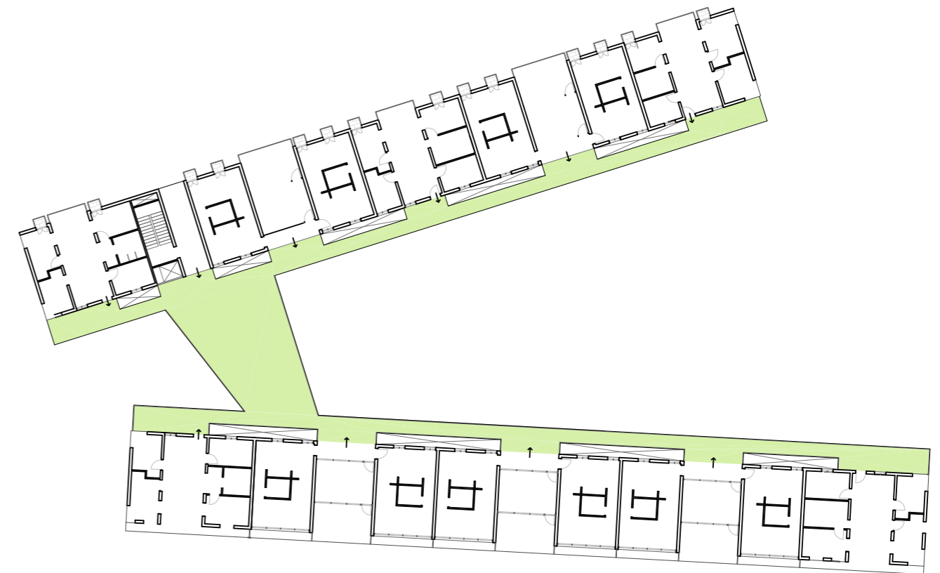
Imagen 68. Planta de viviendas tipo con salida de evacuación a plataforma metálica exenta. Elaboración propia.
