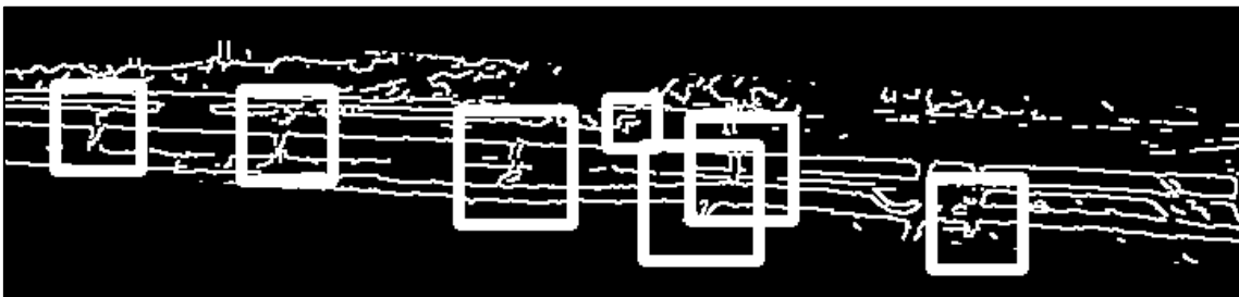
Figura 173. Falsos positivos en la detección de elementos característicos de las caras dorsales de las barreras metálicas.
