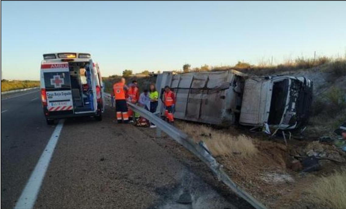
Figura 4. Vuelco de un vehículo pesado tras impactar con un guardarraíl. Fuente: Periódico Hoy, 5 de octubre 2019.
