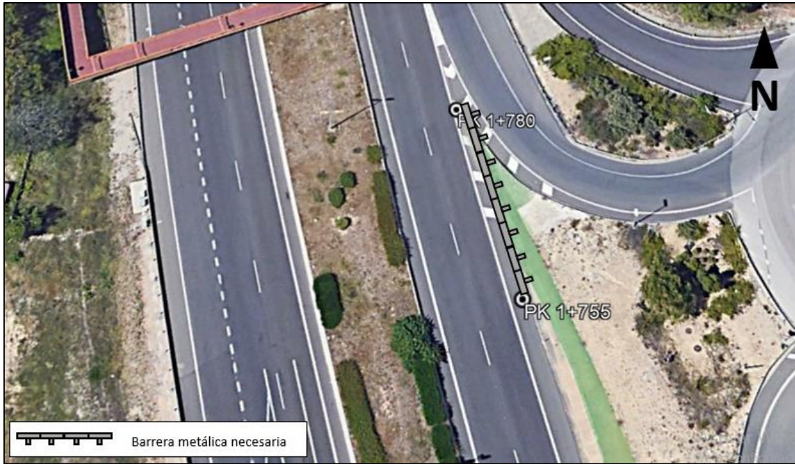
Figura 26. Ubicación de la deficiencia y solución propuesta. Vista en planta. PK 1+780.
