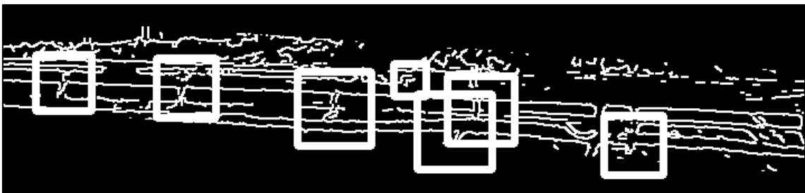
Figura 103. Elemento característico de la cara dorsal de las barreras metálicas , detectado en la imagen tratada. PK 1+295.
