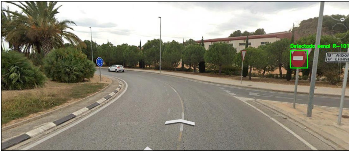
Figura 158. Detección de señal R-101 en el carril de entrada NO
