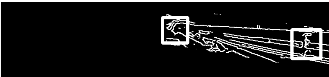
Figura 99. Elemento característico de la cara dorsal de las barreras metálicas, detectado en la imagen tratada. PK 1+780.
