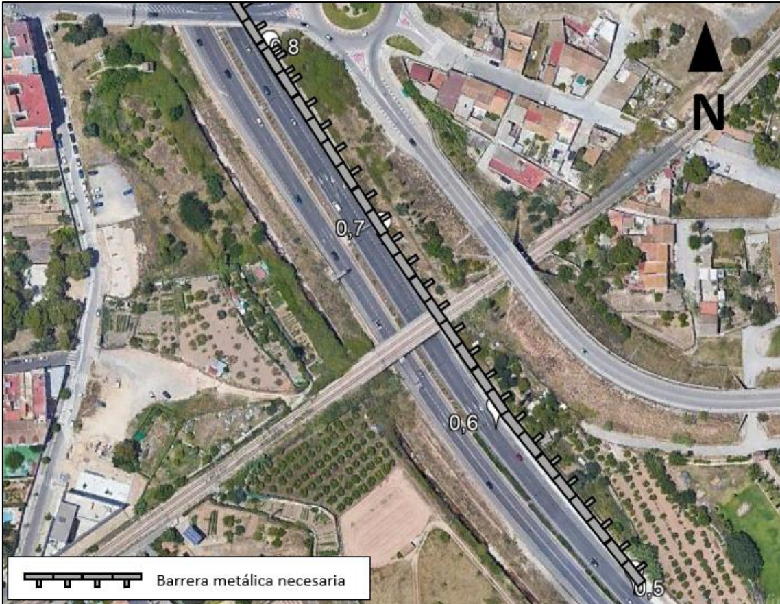
Figura 113. Ubicación de la deficiencia y solución propuesta entre los PPKK 0+550 y 0+750. Vista en planta.
