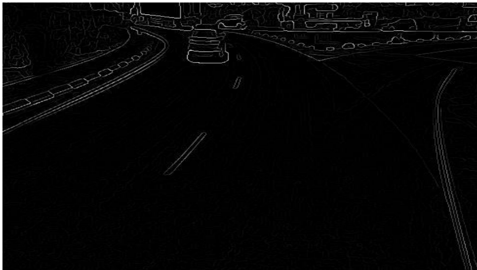
Figura 62. Curvatura característica de los bordes de clazada en la salida de una glorieta. Imagen tratada.
