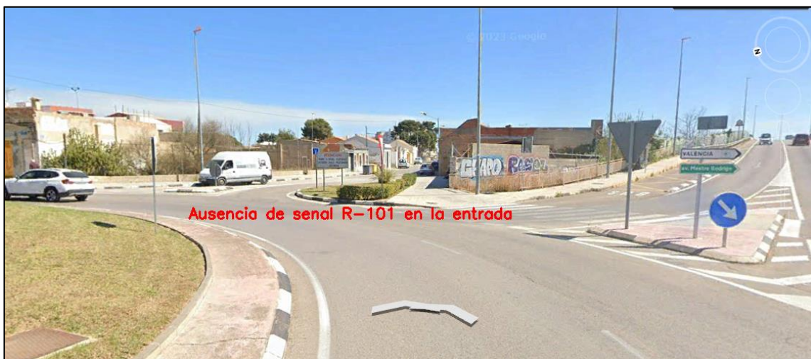
Figura 148. Ausencia de señal R-101 en el carril de entrada S
