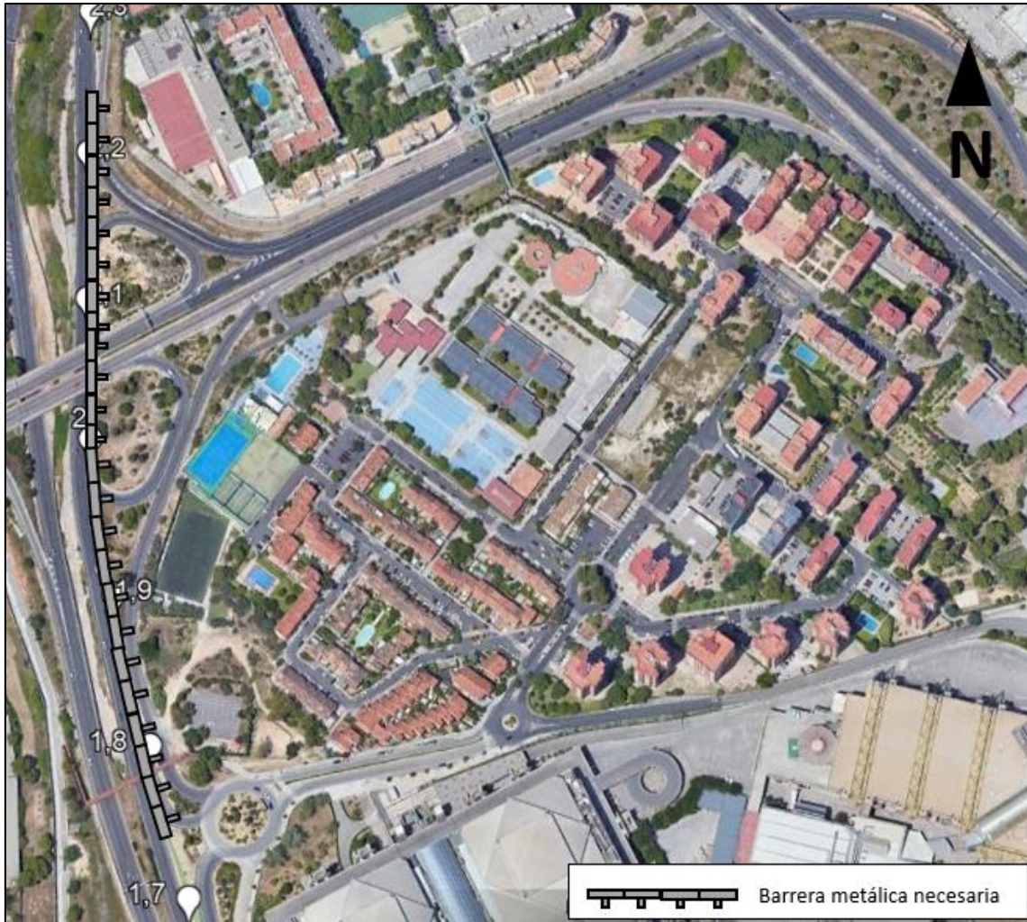
Figura 127. Ubicación de la deficiencia y solución propuesta entre los PPKK 1+750 2+275. Vista en planta.
