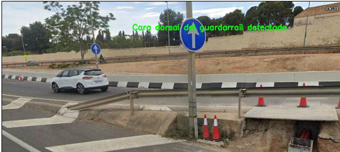
Figura 95. Deficiencia detectada tras la evaluación de la imagen en OpenCV. PK 1+950. Recorte obtenido a partir de la imagen de salida proporcionada por OpenCV.
