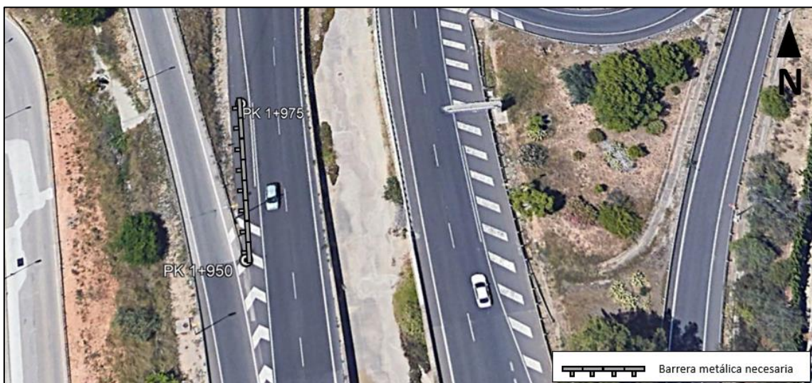
Figura 97. Ubicación de la deficiencia y solución propuesta. Vista en planta
