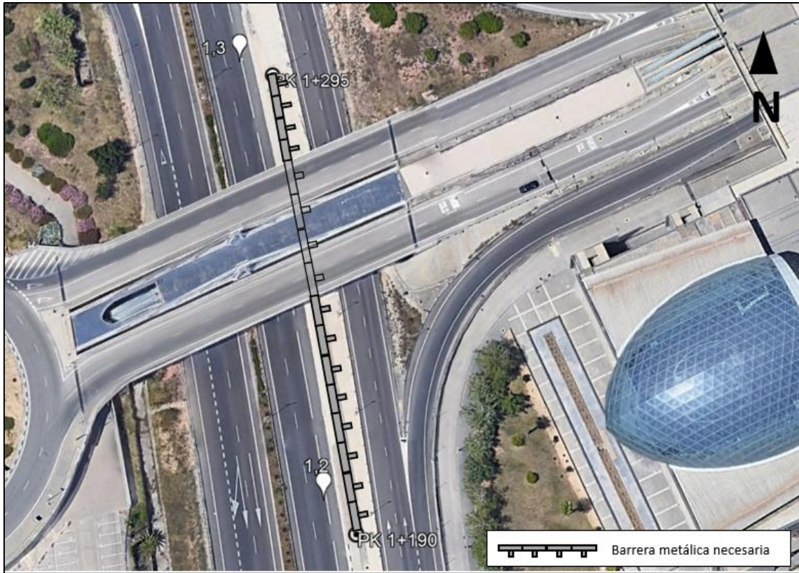
Figura 104. Ubicación de la deficiencia y solución propuesta. Vista en planta. PK 1+190 a 1+295
