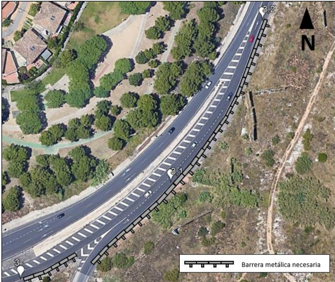
Figura 135. Ubicación de la deficiencia y solución propuesta entre los PPKK 3+000 y 3+200. Vista en planta.
