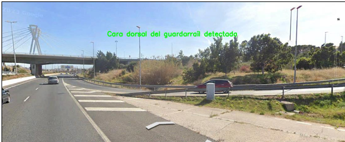
Figura 105. Deficiencia detectada tras la evaluación de la imagen en OpenCV. PK 1+345. Recorte obtenido a partir de la imagen de salida proporcionada por OpenCV.
