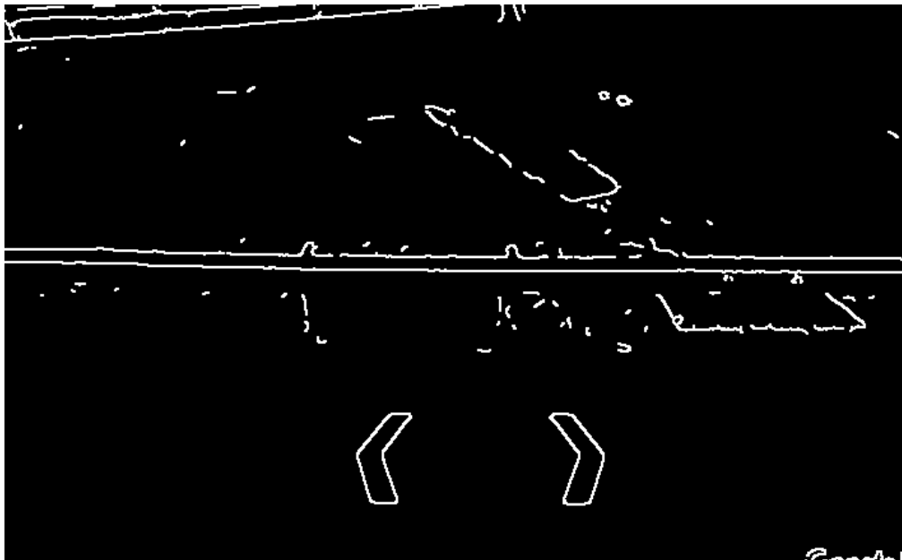
Figura 23. Imagen de la cara frontal de la barrera de seguridad, tras aplicar la función Canny.
