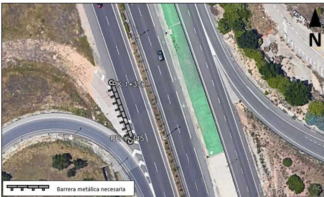
Figura 107. Ubicación de la deficiencia y solución propuesta. Vista en planta. PK 1+345
