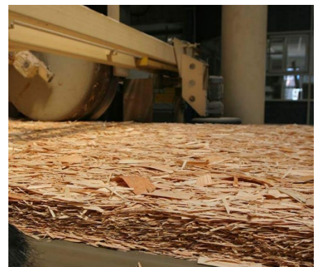
Ilustración 16 - Compactación de las virutas (Fuente: Tallerdelcuadro)
