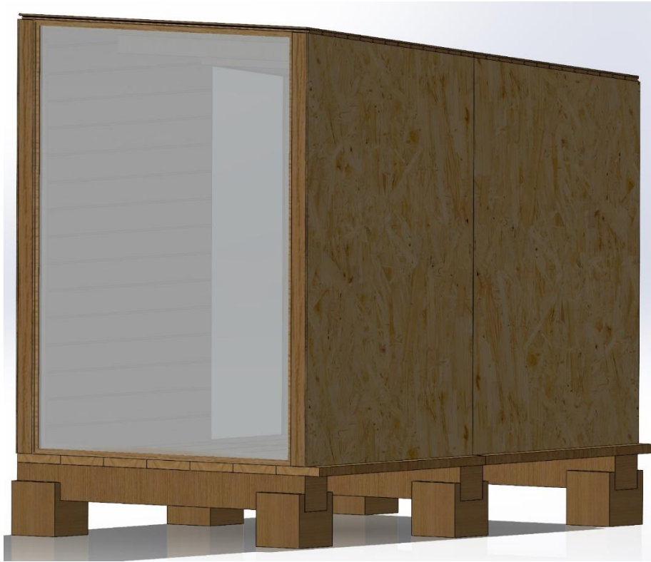
Ilustración 106, colocación del cristal
