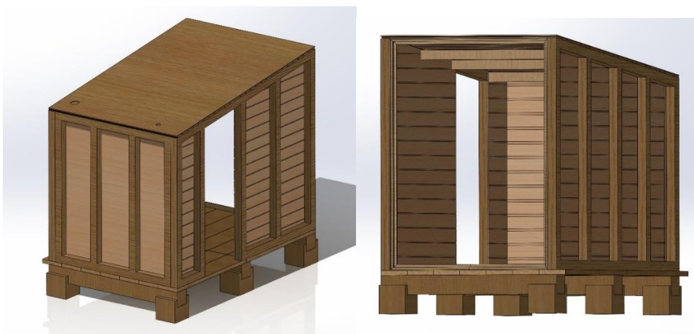
Ilustración 103, montaje del tablado del interior
