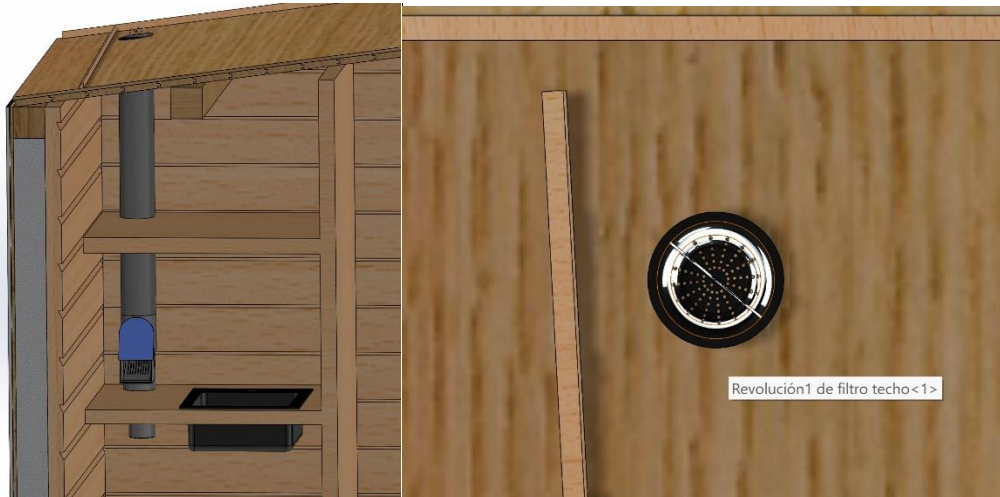
Ilustración 112, colocación del sistema de filtrado de agua de lluvia
