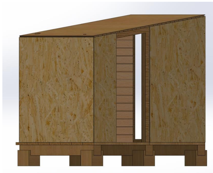
Ilustración 105, montaje del contrachapado
