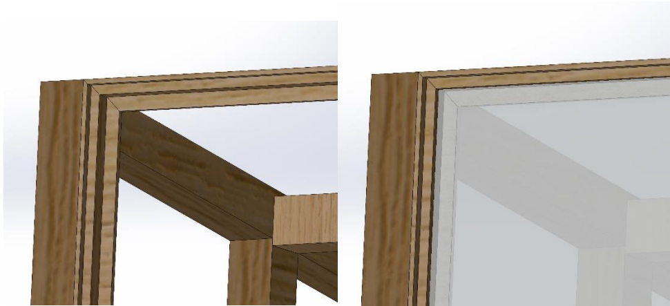
Ilustración 100, vista en detalle del montaje del marco
