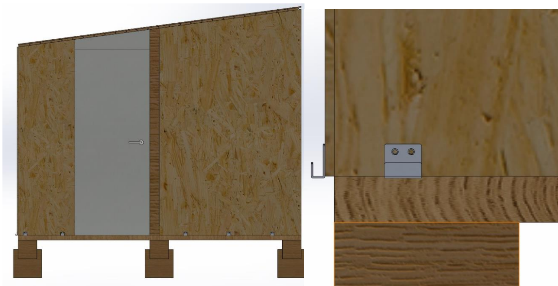
Ilustración 109, tornillado de los ganchos
