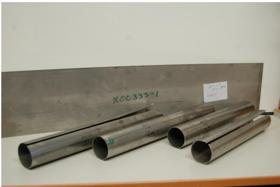
Figura IV.96 Imágenes del fleje y el tubo en distintas fases del proceso de fabricación.
