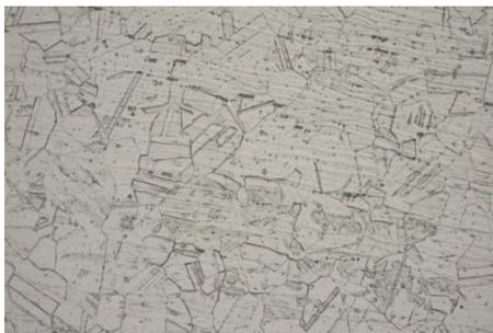
Figura I.22 Metalografía típica de acero inoxidable austenítico
