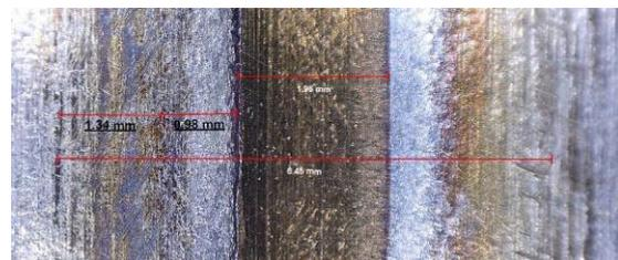
Figura IV.129 Macrografía del cordón de soldadura de alta frecuencia a 50X.
