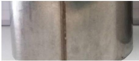
Figura IV.126 vista frontal cordón de soldadura laser.
