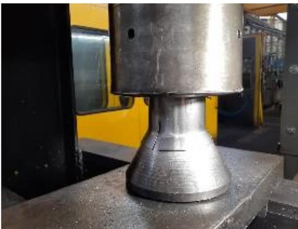
Figura IV.89 Probeta con soldadura NOK. Rompe la soldadura antes de alcanzar el % mínimo exigible de expansión.
