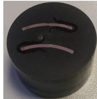
Figura III.14 Pastilla embutida con el material
