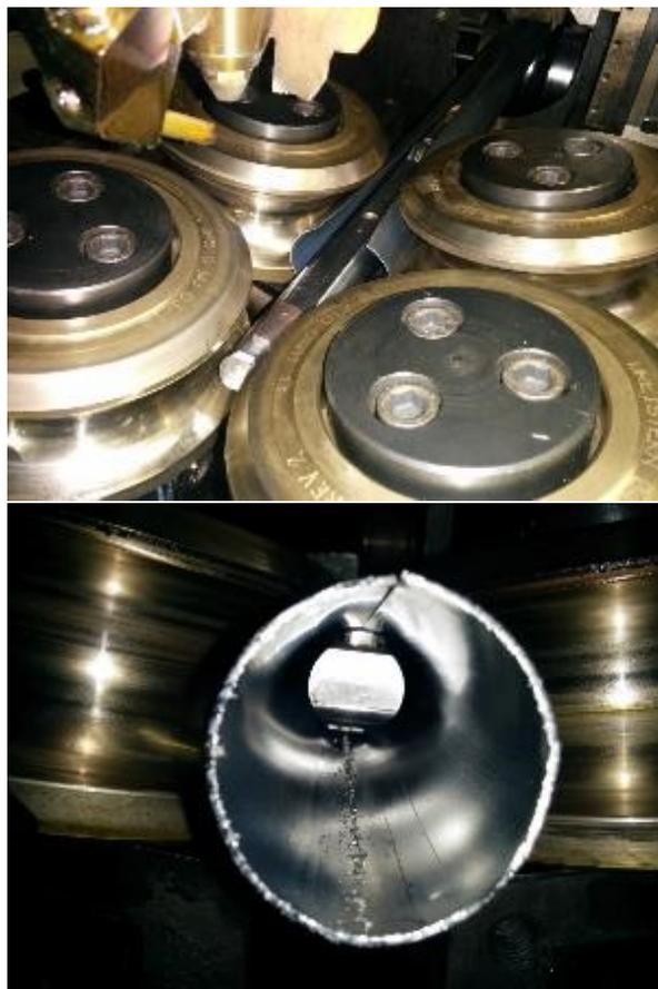
Figura IV.58 Detalle del Sostenedor de cantos posicionado en el interior del tubo.
