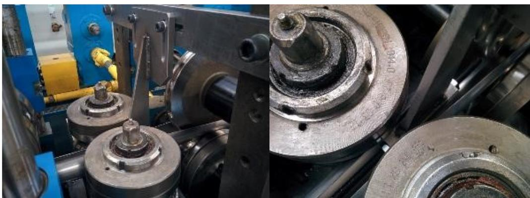
Figura IV.54 Útil de ensamblaje instalado en la conformadora de la máquina.
