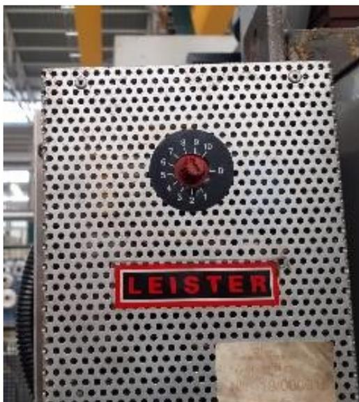
Figura IV.79 Potenciómetro selector de la resistencia del horno túnel
