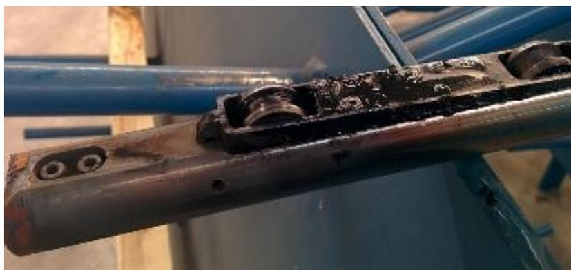
Figura IV.60 Detalle de la degradación de la grasa resistente a la temperatura utilizada en la base con ruedas del sistema sostenedor de cantos.
