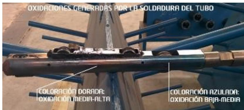
Figura IV.61 Estado de oxidación del sostenedor de cantos tras la realización de las 4 pruebas realizadas.
