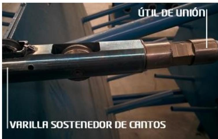
Figura IV.55 Útil de unión entre el sostenedor de cantos y el útil de ensamblaje.
