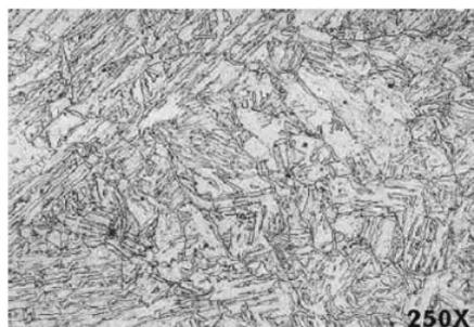
Figura I.16 Metalografía típica acero inoxidable martensítico después del temple.
