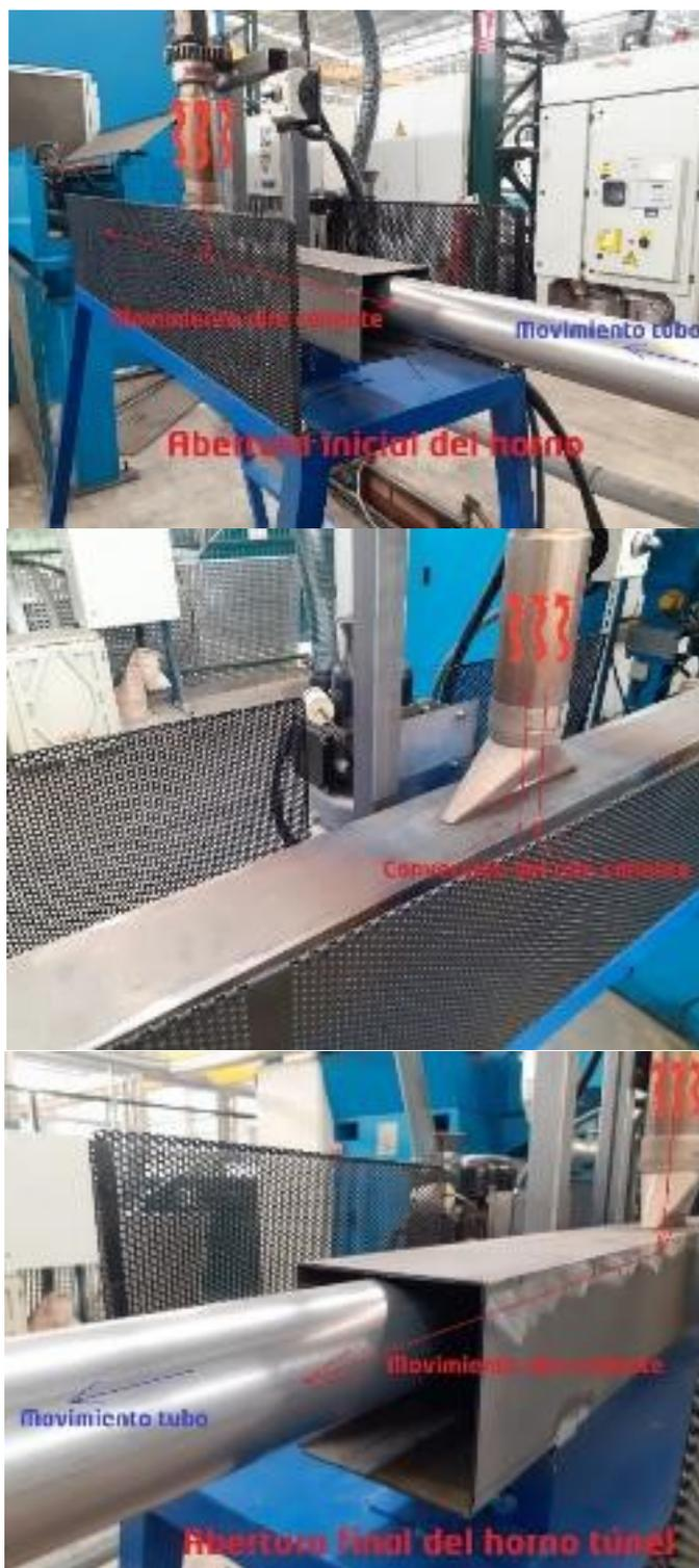
Figura IV.90 Vías de evacuación del aire caliente dentro del horno túnel.
