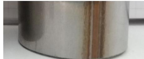
Figura IV.127 Vista frontal cordón de soldadura de alta frecuencia.
