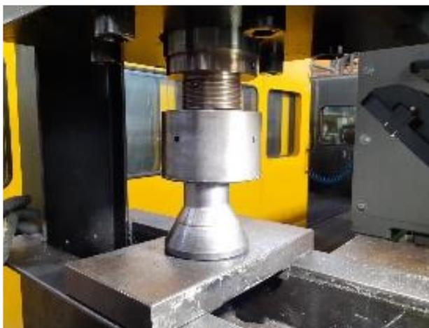
Figura IV.88 Probeta con soldadura OK. Resiste el esfuerzo del ensayo de abocardado >25% sin rotura.
