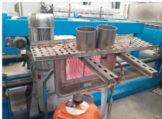
Figura IV.72 Calentamiento de probetas con estufa de butano.
