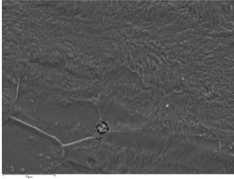
Figura IV.13 Imagen SEM de retrodispersados y distribución de elementos aleantes en el acero AC2 - 1.4509.
