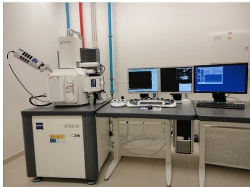
Figura III.8 Microscopio electrónico de barrido
