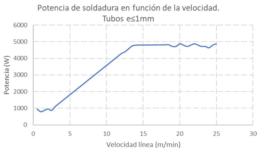
Figura IV.50 Potencia y velocidad para tubos de  $e \leq 1\text{mm}$
