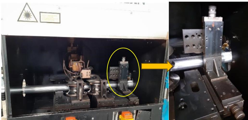
Figura IV.63 Cabina de soldadura láser con soporte del rodillo aplastador instalado a su derecha.
