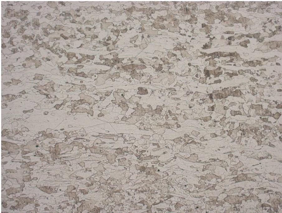
Figura III.18 Ejemplo de ataque en material 1.4512, 100x, reactivo Villela
