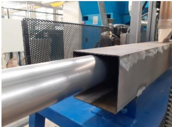
Figura IV.81 1ª prueba del sistema horno túnel. Tubo Ø60.
