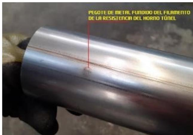
Figura IV.91 Pegote sobre el tubo del filamento fundido de la resistencia.
