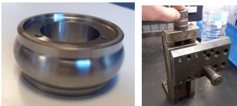
Figura IV.62 Rodillo de aplastado de bordes y soporte de rodillo.
