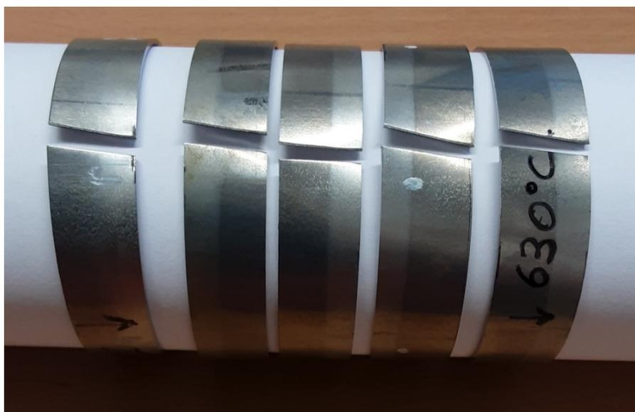
Figura IV.117 Apertura del tubo de diámetro de 60 mm tras el corte por cizalla. De izquierda a derecha; tubo a temperatura ambiente, tratado a 180°C, 320°C, 510 °C y 630°C.
