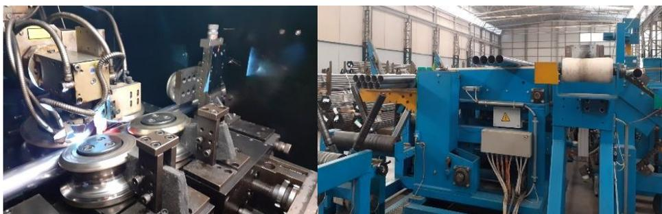
Figura IV.65 Soldadura del tubo 55x0.8 calidad 1.4512. - Tubos 55x0,8mm del inicio de la fabricación.
