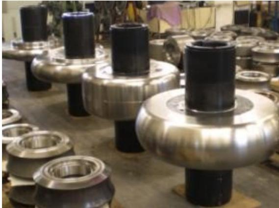
En esta otra imagen, se ve la secuencia de paso de los rodillos superiores de la etapa de formación, y como la huella que va dejando el rodillo sobre la banda va de más a menos. Como se observa en la imagen de más abajo, en la secuencia que sigue la banda hasta llegar a la soldadura.
