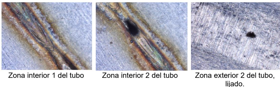
Figura IV.67 defectos producto de la velocidad de proceso.
