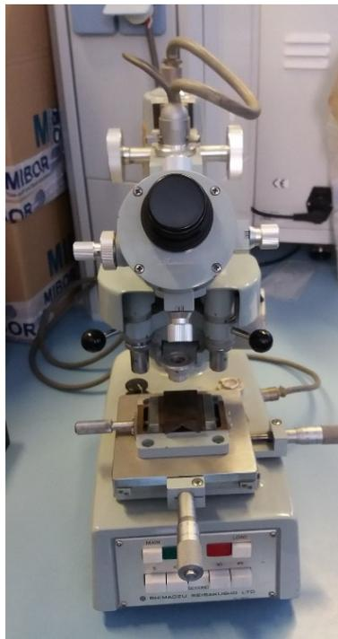
Figura III.2 Micro durómetro Shimadzu (UPV-Alcoy)
