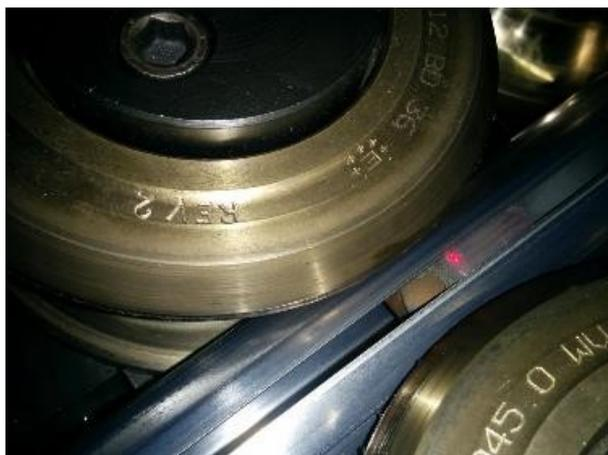
Figura IV.59 Detalle del punto donde se realizará la soldadura en la parte final de la pastilla de soporte.
