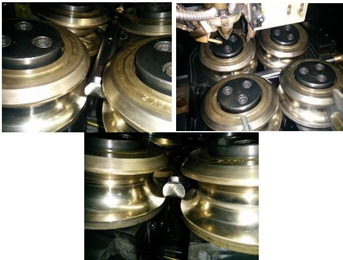
Figura IV.56 Sostenedor de cantos posicionado entre los rodillos del cabezal de soldadura.
