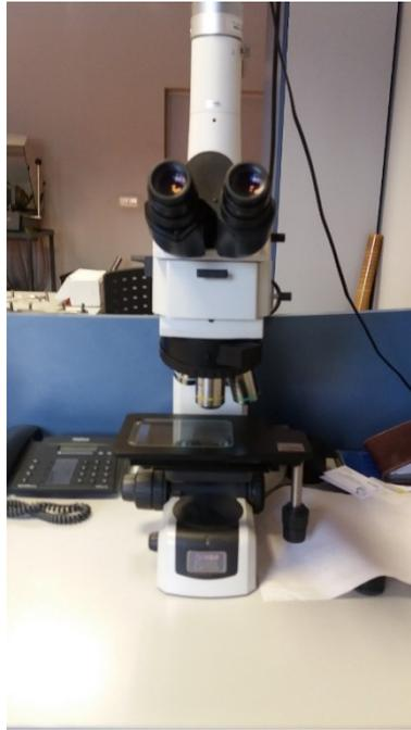
Figura III.7 Microscopio óptico
