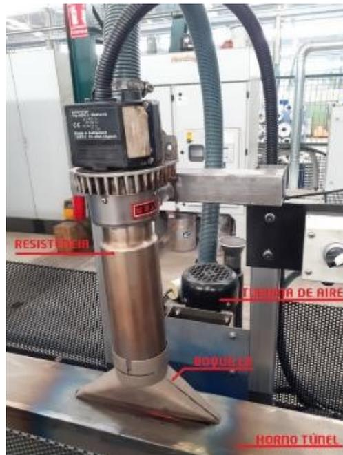
Figura IV.82 Subsistema del horno túnel. Generación de aire mediante turbina y calentamiento con resistencia.
