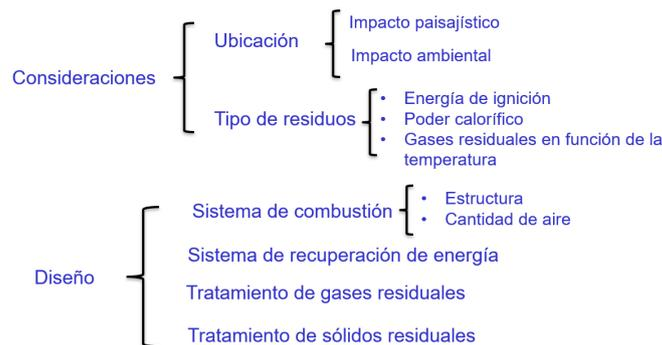
Figura 5: Esquema de diseño de una planta de incineración
