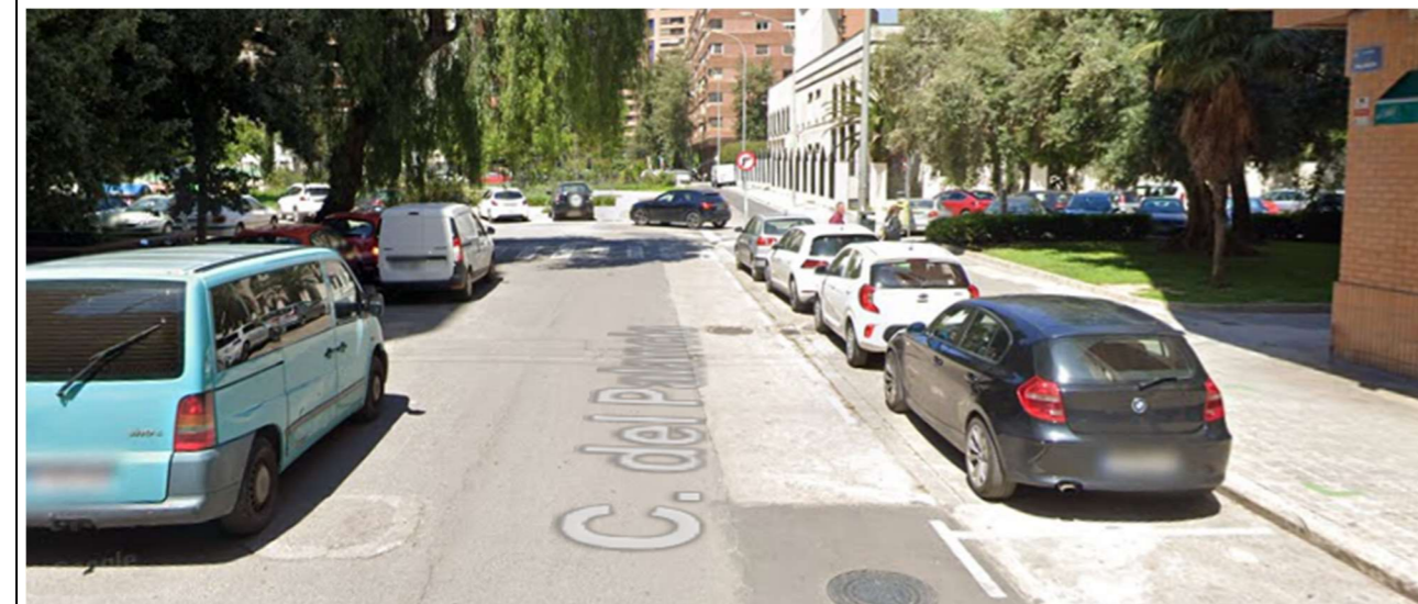
Imagen 12. Calle Palancia antes de intersección con calle Rubén Darío. El sobrecancho de calzada lleva al estacionamiento habitual ilegal en doble fila. Fuente: Google Maps.
