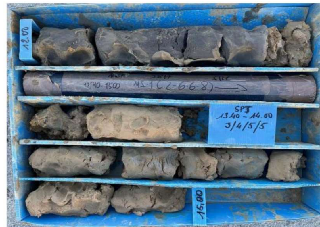
Figura 11. Muestras del sondeo S-1, de profundidad 12,00 metros hasta el fin del sondeo, mostrando los limos no plásticos. (Fuente: Campaña sondeos)
