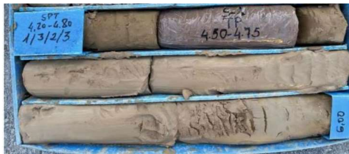
Figura 10. Muestras del sondeo S-1, de profundidad 4,20—6,00 metros, mostrando los limos plásticos. Nótese la tonalidad más oscura en la parte no saturada. (Fuente: Campaña sondeos)
