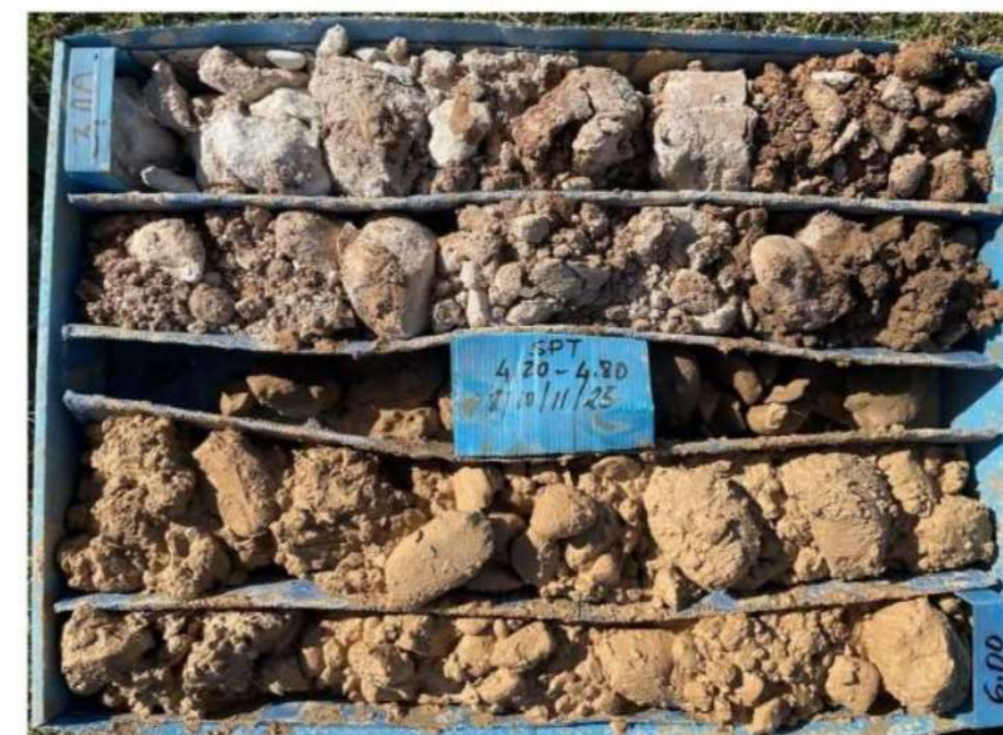
Figura 9. Muestras del sondeo S-2, de profundidad 3,00—6,00 metros, mostrando exclusivamente las gravas. Nótase cambios por el N.F. a partir de la profundidad 4,52 m. (Fuente: Campaña sondeos)
