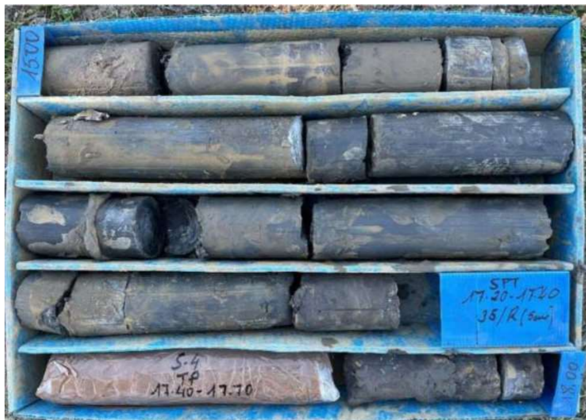
Figura 12. Muestras del sondeo S-4, de profundidad 15,00—18,00 metros, mostrando las arcillas duras (Fuente: Campaña sondeos)
