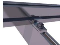
Detalle fijación G1 a triángulo
