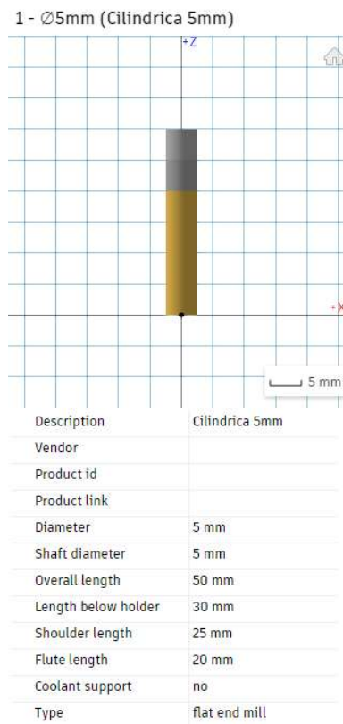
Figura 102: Fresa cilíndrica \phi 5\text{mm} .
