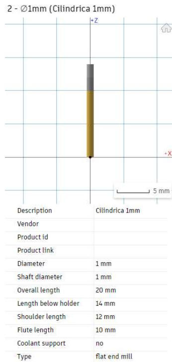
Figura 109: Fresa cilíndrica \phi 1mm.
