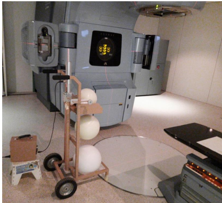
Figure 2. BSS detector at the radiotherapy bunker and the Varian Clinac at the “Hospital Universitari I Politècnic La Fe de València”.
