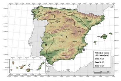
Figura D.1 Valor básico de la velocidad del viento, v
