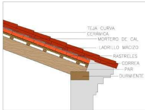
Figura 50. Sección cubierta existente en vivienda. Fuente propia
