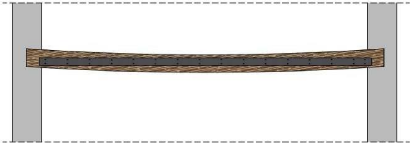
Figura 106. Pletinas viga. Fuente propia
