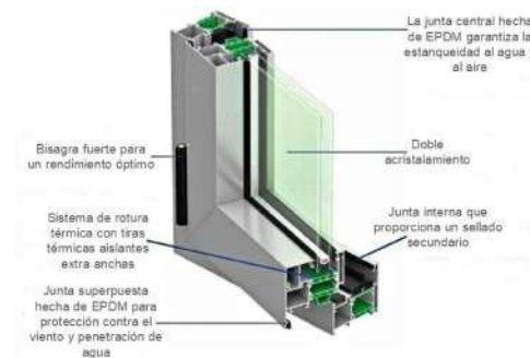
Figura 141. Carpintería con rotura de puente térmico y doble vidrio. Alumedistemas.com
