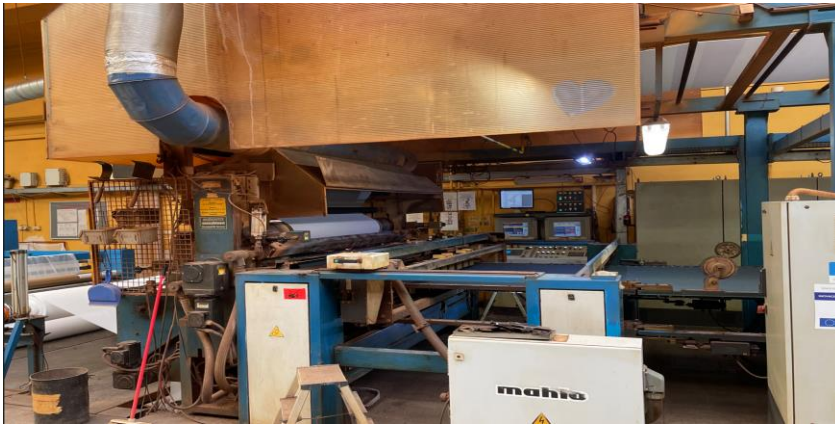
Imagen nº 43.Zona rame , calandras , extracción de humos (laminadora a la llama empresa Sage Chequia)
