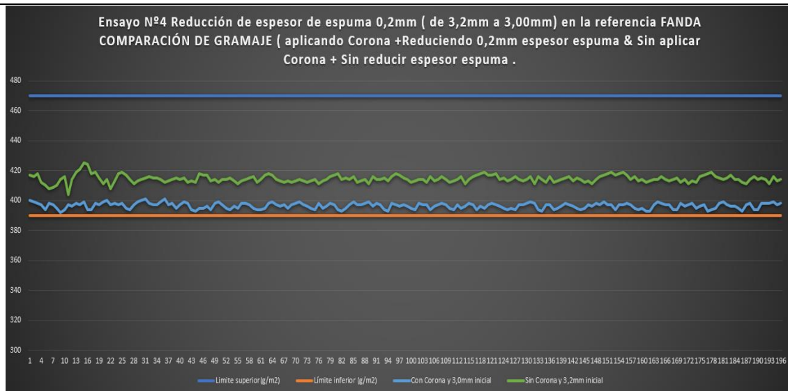
Imagen nº 61. Comparación gramaje (aplicando Corona y reduciendo espesor inicial espuma / Sin aplicar corona y sin reducir espesor inicial). Fuente propia
