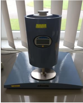
Imagen nº 48 Equipo de laboratorio "Rainbow" utilizado para medir espesores
