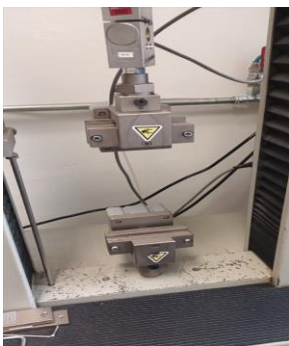
Imagen nº 49 Equipo de laboratorio "Instron " utilizado para medir adherencias.
