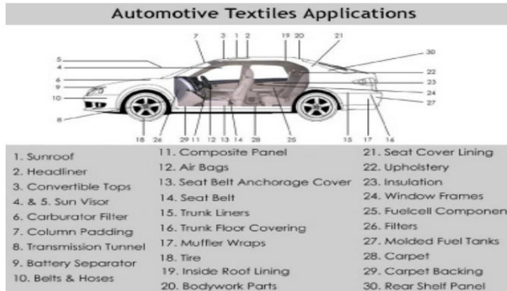
Imagen nº 4 Partes del vehículo donde se utilizan textiles. Fuente (Parmar, S., & Malik, T. (2016). Application of textiles in automobiles.)
