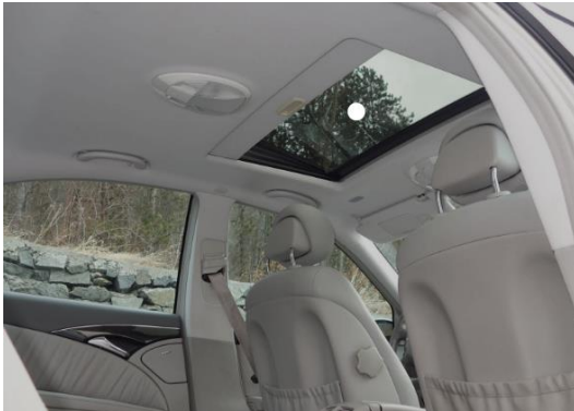
Imagen nº 12. Ejemplo de techos realizados con textil
