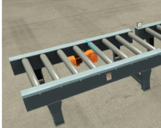
**Figura 5.3:** Transportador de rodillos
